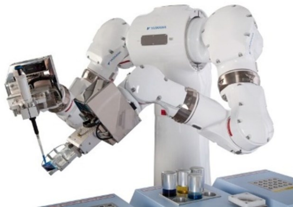
Obrázek 2.5 – Dvouramenný robot Yaskawa Motoman v biologické verzi (MM SCIENCE JOURNAL, 2014)
