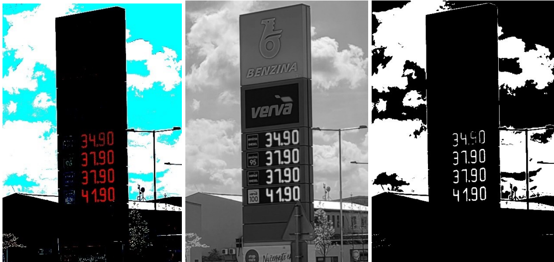
Obrázek 16: Prahování barevného obrazu, kanál R z barevného prostoru RGB a jeho prahování
