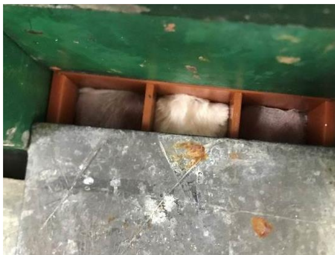
Obrázek 13 - A – Uložení myši do plastových kójí, B – Odstínění olověnými bloky, C – Clonění.
