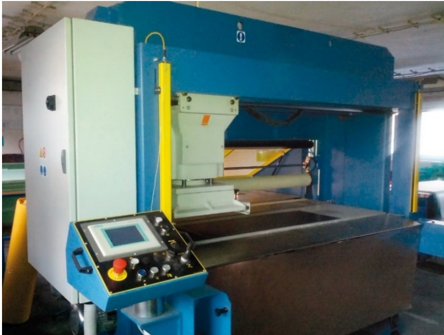
Obrázek 5 - CNC vysekávací poloautomat
