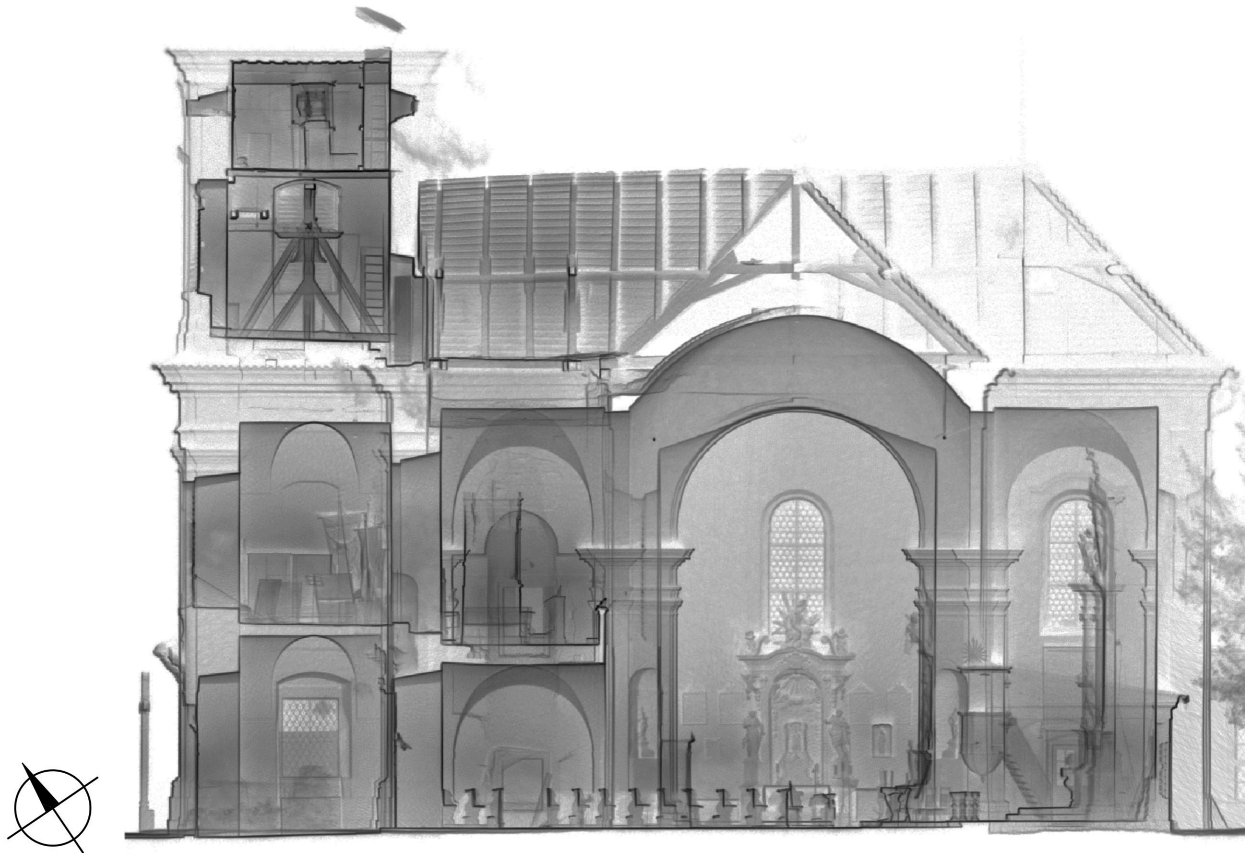
7. Podélný řez, pohled na sever, M 1:100. Výstup z mobilního skeneru ZEB-HORIZON (GeoSLAM)
