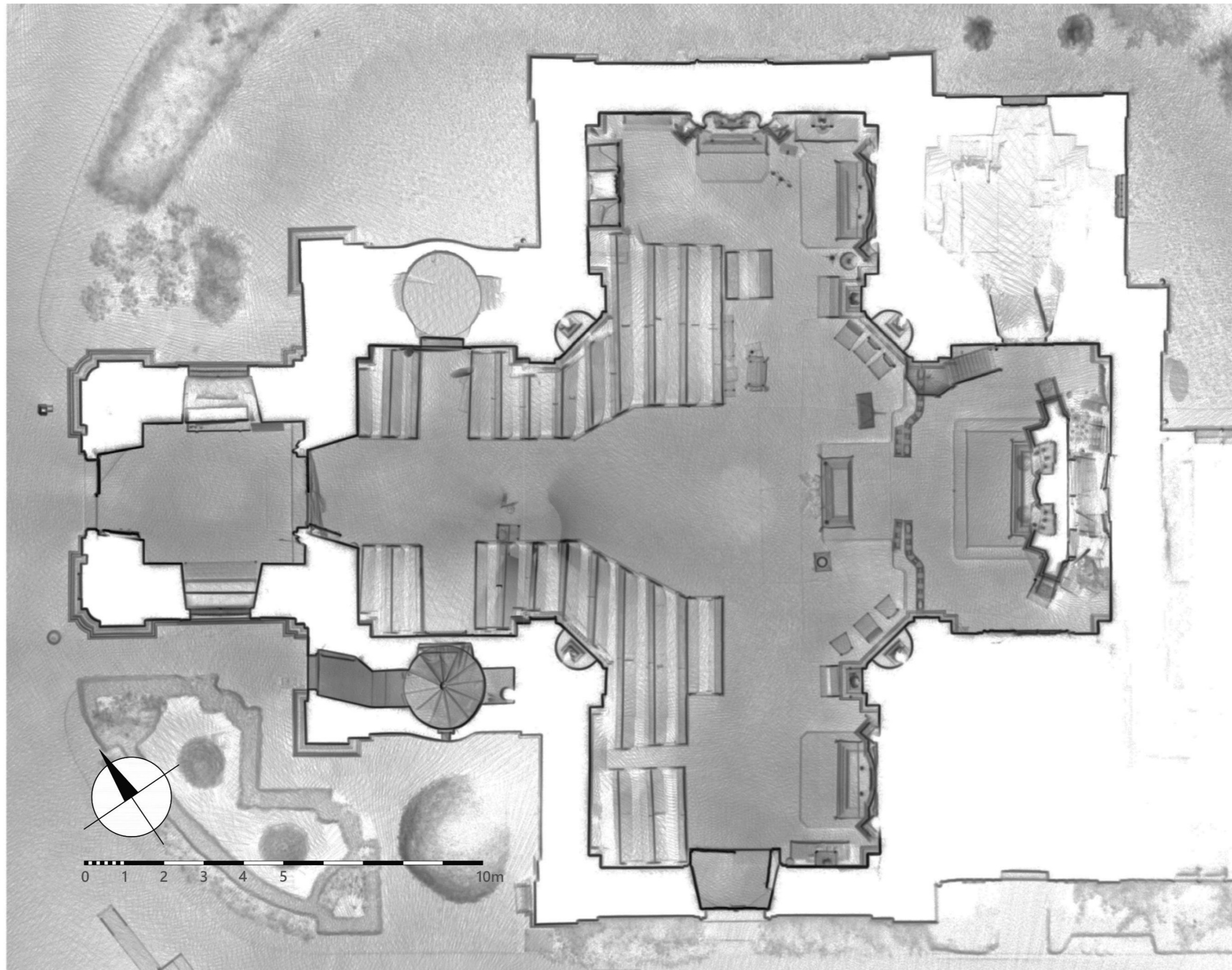
6. Půdorys přízemí, M 1:100. Výstup z mobilního skeneru ZEB-HORIZON (GeoSLAM)
