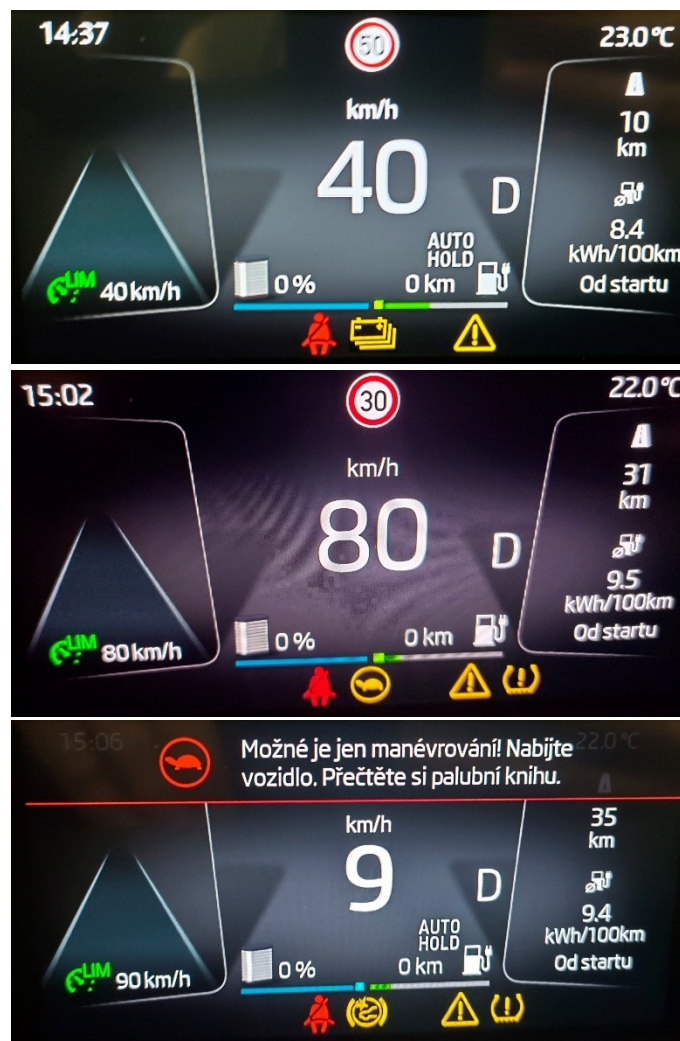
Obrázek 32 – Informace o nízké stavu nabití baterie na kombi přístroji
