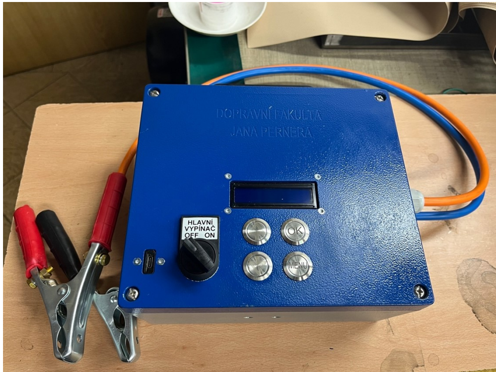
Obrázek 21: Pohled na konstruovaný startovací zdroj (autor)
