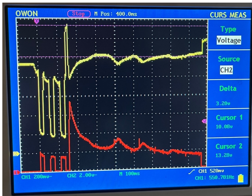
Obrázek 40: Start vozidla Škoda Octavia s vadným akumulátorem 2 (autor)
