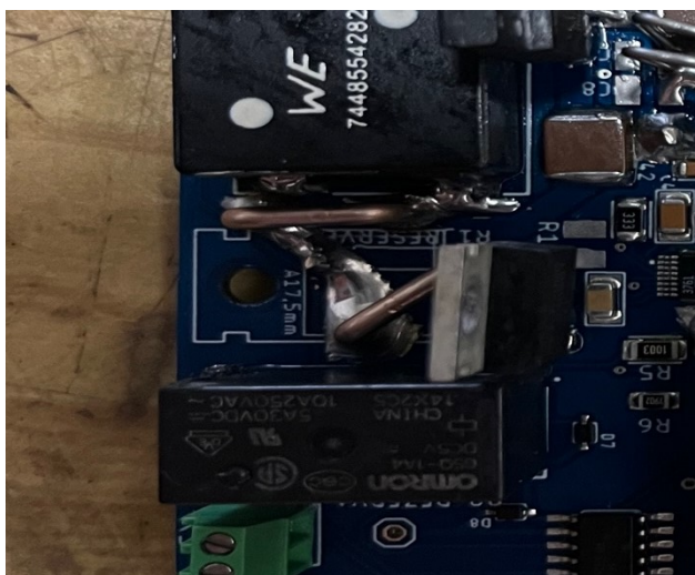
Obrázek 36: Dodatečné propojky DPS (autor)
