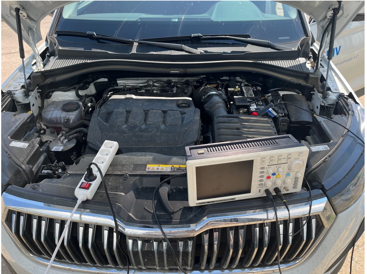
Obrázek 18: Měření startovacích parametrů na vozidle Škoda Kodiaq (autor)
