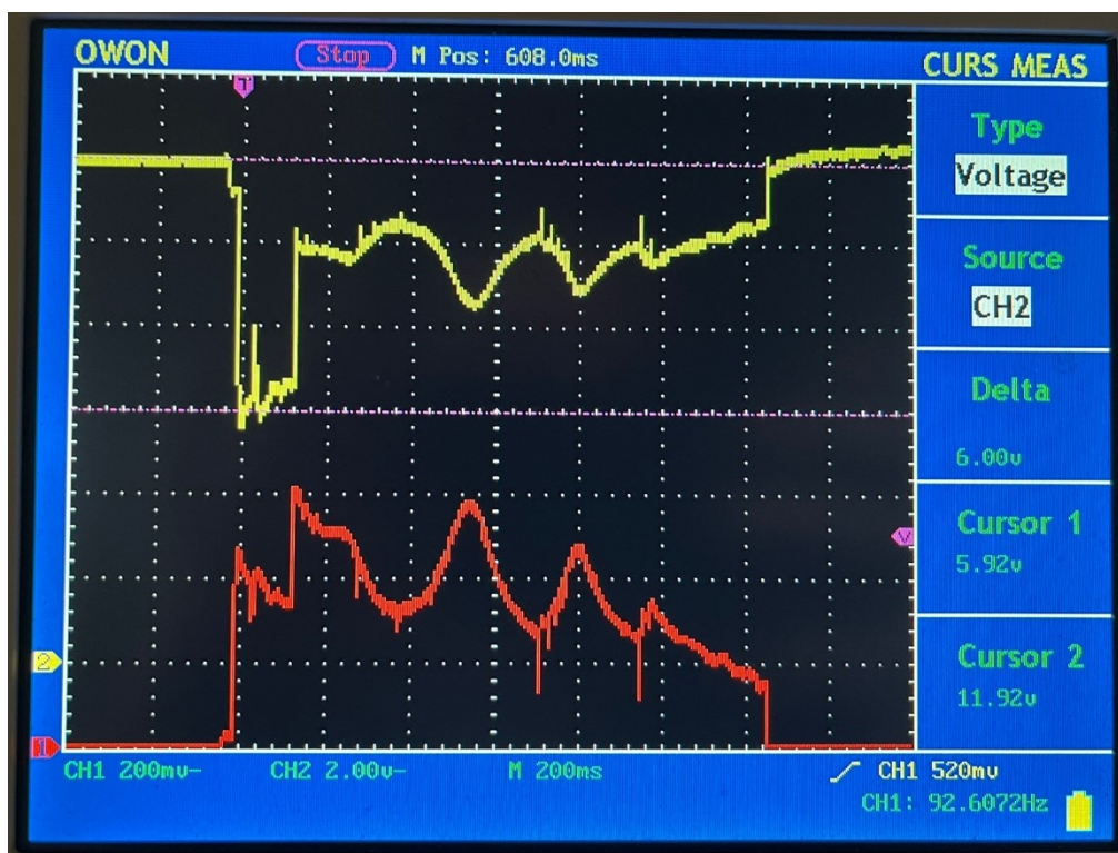
Obrázek 39: Start vozidla CAT 428B s vadným akumulátorem
