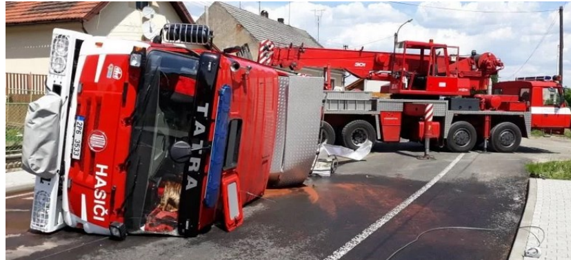
Obrázek 2 Nehoda požárního vozidla CAS v důsledku ztráty stability [2]
