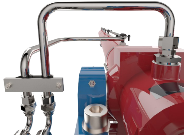
Obrázek 82 Vedení hydraulických trubek na válci
