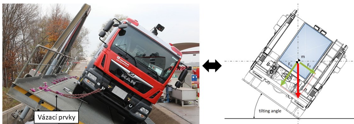
Obrázek 5 Zkouška klopné stability ve firmě Rosenbauer v porovnání se silovým schématem zkoušky [3]
