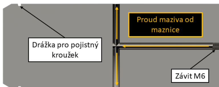
Obrázek 61 Řez válcovým čepem
