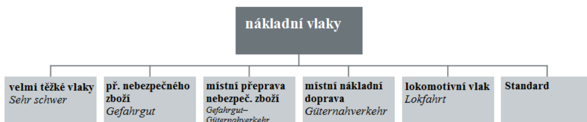
Obrázek 2 Schéma rozdělení nákladních vlaků na síti DB Netz (autor)
