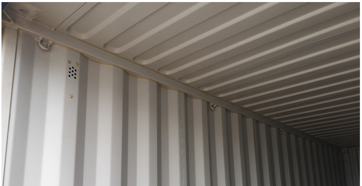
Obrázek 3 Oka k zafixování nákladu uvnitř kontejneru (autor)
