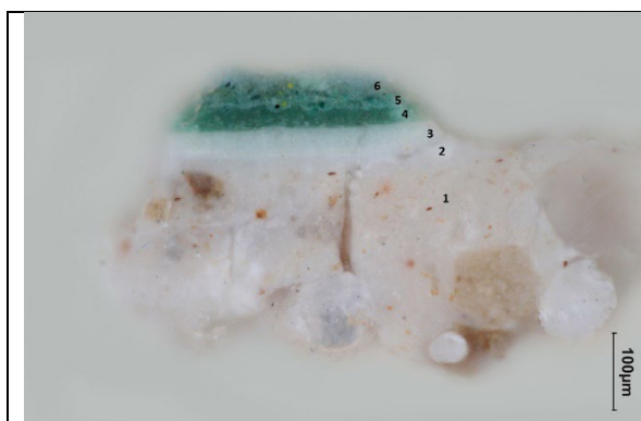
Nábrus, bílé dopadající světlo, fotografováno při zvětšení mikroskopu 200x
