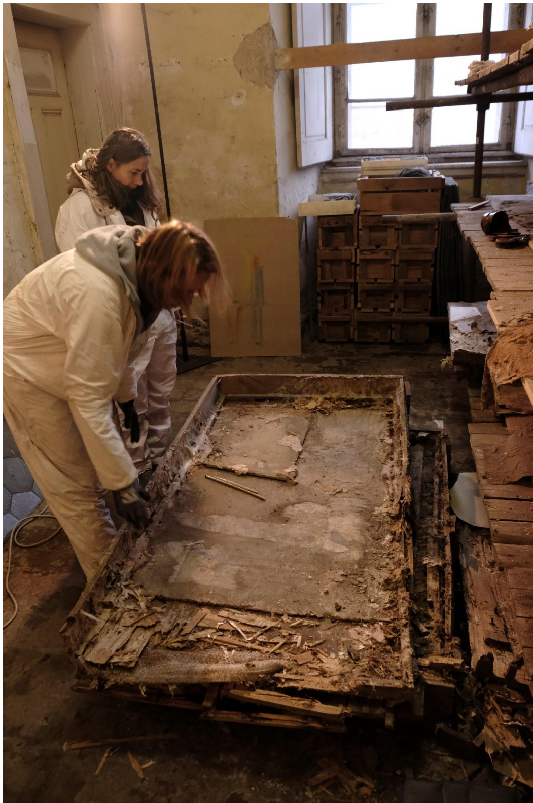
Obr. 3 Stav plochých beden a transferů v místnosti 1 – napadení dřevokaznou houbou
