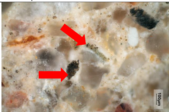
Bílé dopadající světlo, fotografováno při zvětšení mikroskopu 100x; detail s fragmenty slínkových částic (označeny šipkami)
