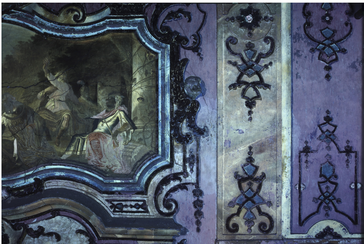
Obr. 68: Snímek dokumentující detail nástěnné malby se štukovou výzdobou v UV záření. Na snímku lze pozorovat žlutooranžovou fluorescenci v oblastech mramorování a modrobílou fluorescenci na štukovém rámu lemujícím zrcadlo s nástěnnou malbou. Severní stěna zámecké kaple.
