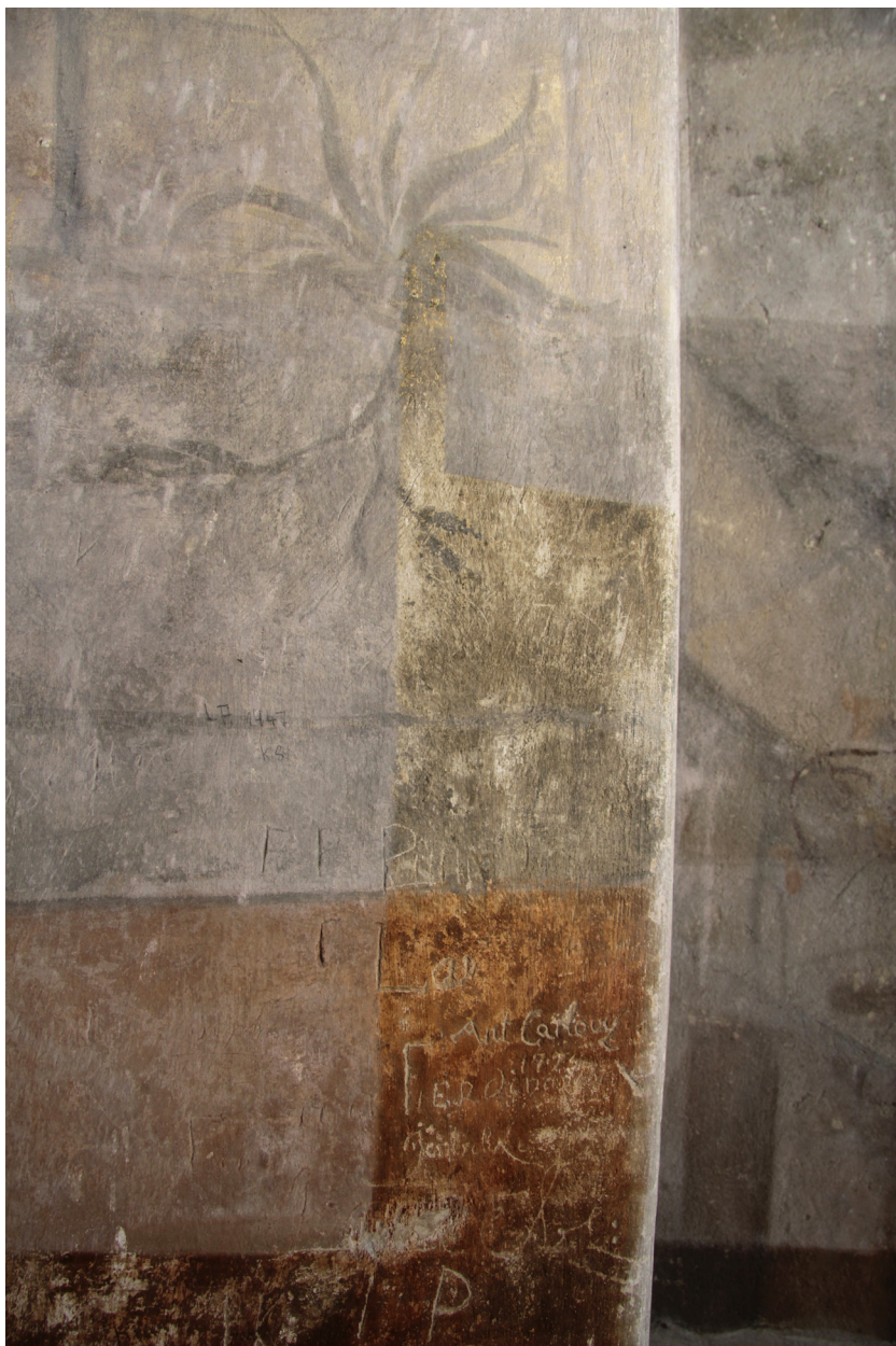
Obr. 73: SV stěna: okenní špaleta. Rozšířená zkouška odstranění sádrovcového zákalu čisticí houbou Akapad hard a čisticím štětcem.
