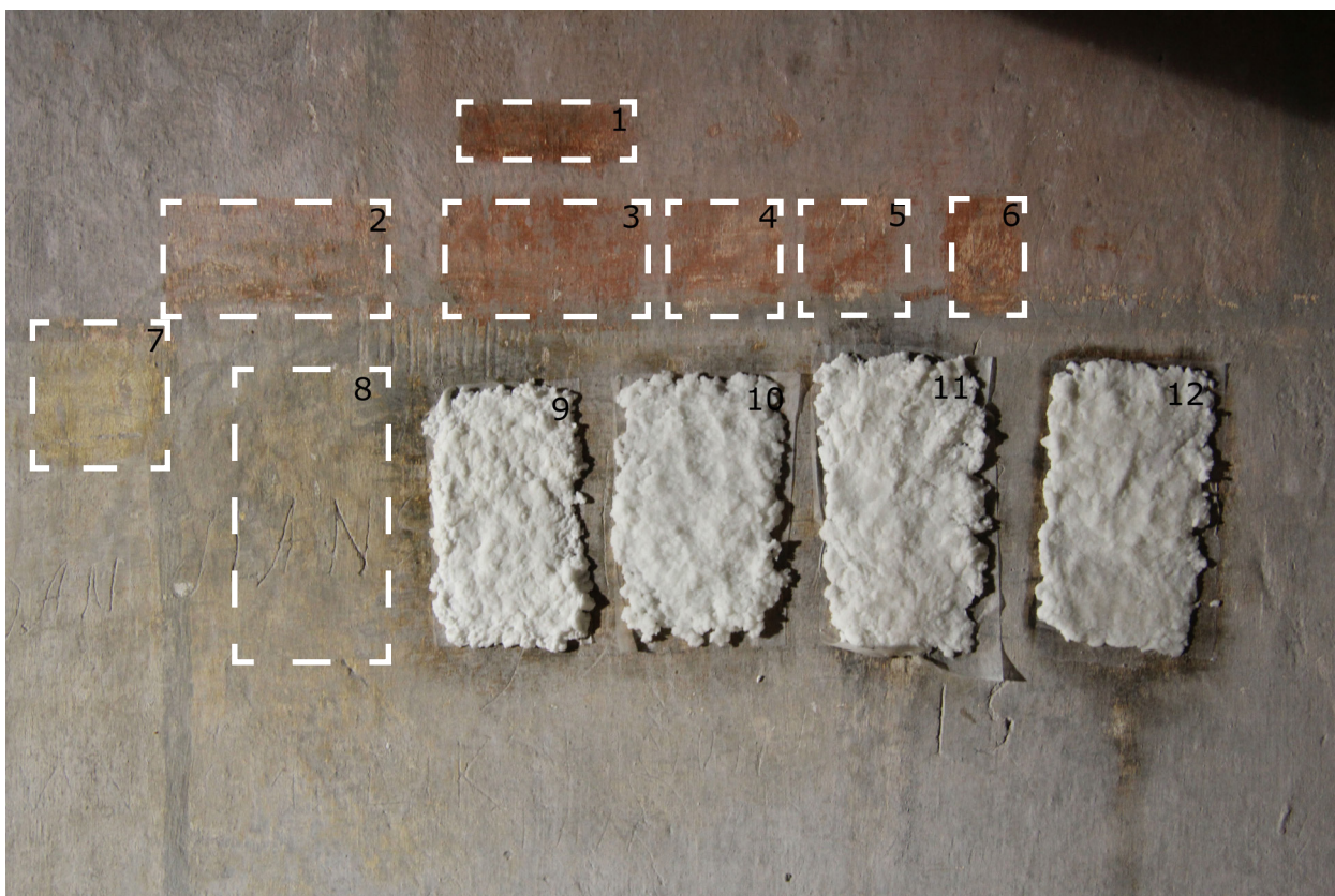
Obr. 68: SV stěna: okenní špaleta. Zkoušky odstraňování sádrovcového zákalu: 1 – voda a Akapad hard ; 2 – jemný čistící štětec; 3 – Akapad ultra hard ; 4 – Akapad white flexi ; 5 – Akapad hard ; 6 – tvrdý čistící štětec; 7 – jemný čistící štětec; 8 – Tylose MH 300 ve vodě přes japonský papír; 9 – Arbocel BC 200 + 5% (hm.) uhličitán amonný; 10 – Arbocel BC 200 + Ethomeen C25 s vodou 300 : 1; 11 – Arbocel BC 200 + líh; 12 – Arbocel BC 200 + voda.
