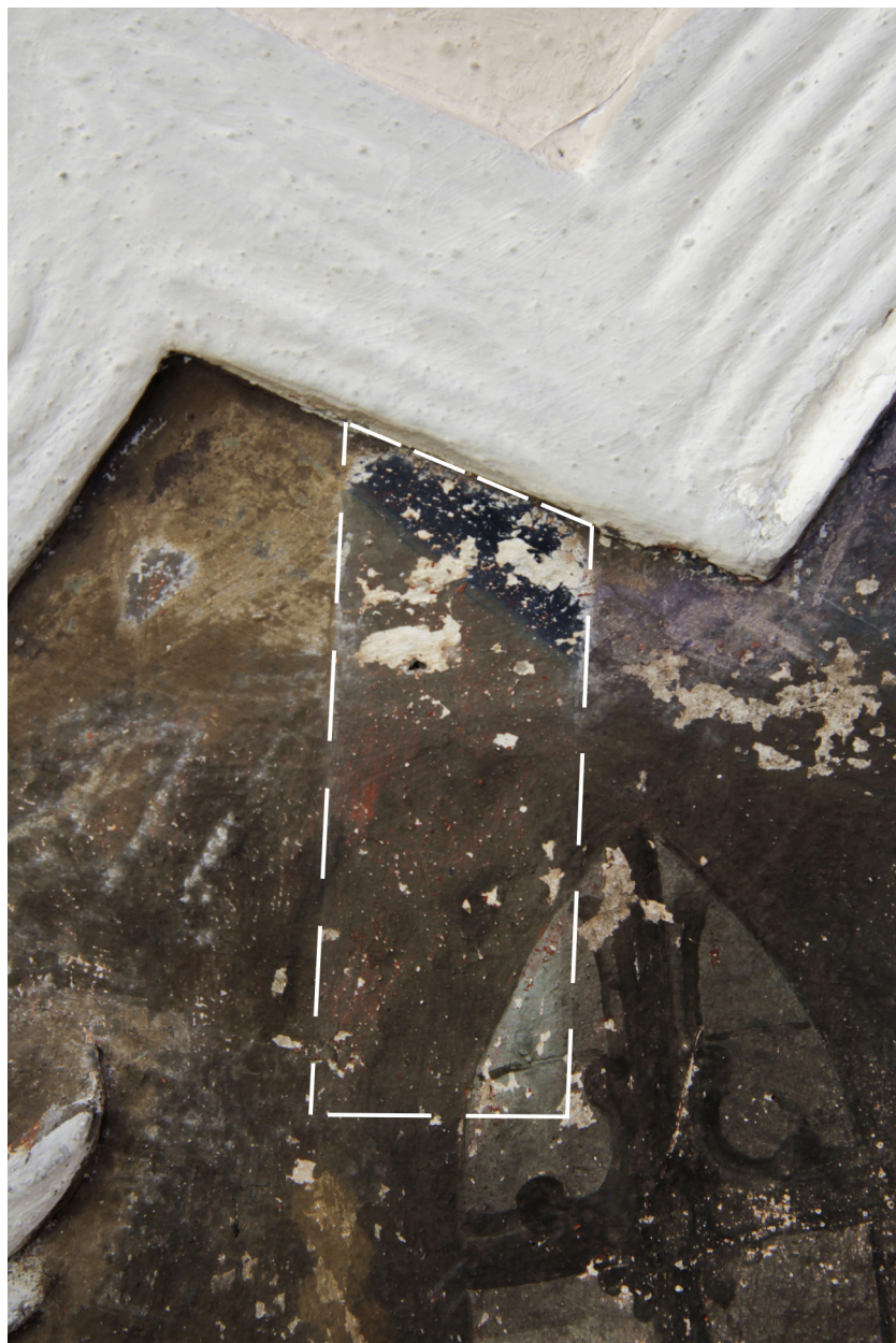
Obr. 41: Zkouška čištění a odstranění přemalby pomocí detergentu – levá horní část výjevu Ohledání jazyka Jana Nepomuckého .
