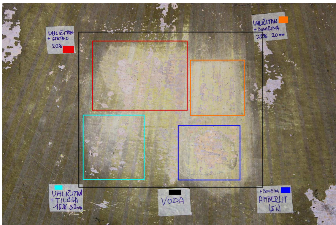
Obr. 42 Barevné zakreslení výsledků zkoušek odstranění přemalby z 19. stol. pomocí mokrých a chemických prostředků. Oblast oblohy. Stav v průběhu zkoušek technologií a materiálů.
