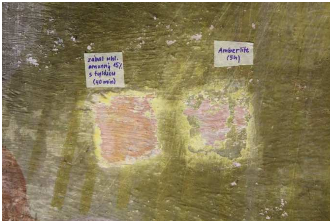
Obr. 38 Zkoušky odstranění přemalby z 19. stol. chemickými prostředky. Vlevo zkouška odstranění pomocí zábalu z 15% (hm.) roztoku uhličitanu amonného v Tylose s dobou působení 40 min, vpravo pomocí zábalu z iontoměniče Amberlite 4400 OH s dobou působení 5 h.
