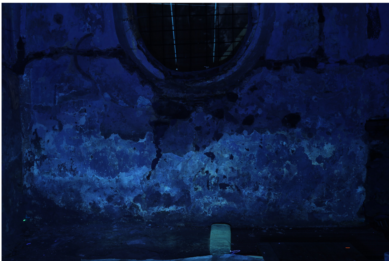
Obr. 32 UV fluorescenční fotografie. Dolní část jižní stěny. Na snímku je pozorována bílá luminiscence v místech poškození omítek vodorozpustnými solemi.
