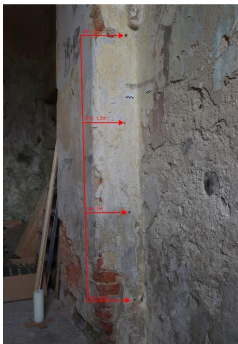
Obr. 1 Místa odběrů vzorků určených ke stanovení obsahů vlhkosti a množství vodorozpuštěných solí, severovýchodní roh presbytáře, celkový pohled. Odběr ve čtyřech výškových (0,5 m, 1 m, 1,5 m, 2 m) a následně čtyřech hloubkových úrovních (0–2 cm, 2–5 cm, 5–10 cm, 10–15 cm).
