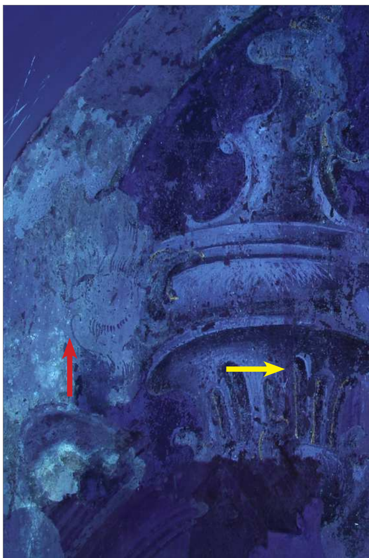
Obr. 47 Detail levé vázy v UV záření. Červenou šipkou je označeno místo, na kterém se nachází vápenná vrstva, přes kterou je viditelné zlacení z rokokové vrstvy. Žlutou šipkou je označena žluto-oranžová luminescence, kterou luminuje organický podklad pod zlacení. Stav po odkryvu.
