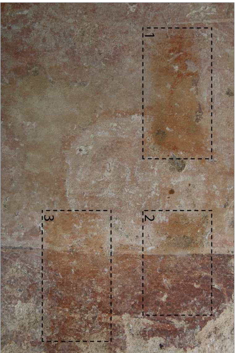
Obr. 48 Zkouška suchého čištění ve spodní části restaurovaného úseku. 1. Akapad , 2. Voda + čistící štětec, 3. Wallmaster .
