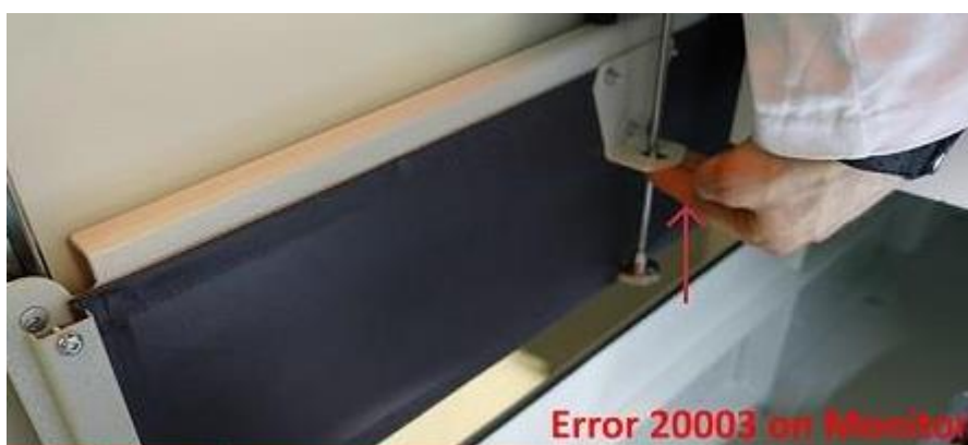
12. Kontrola ochranného bezpečnostního zařízení
