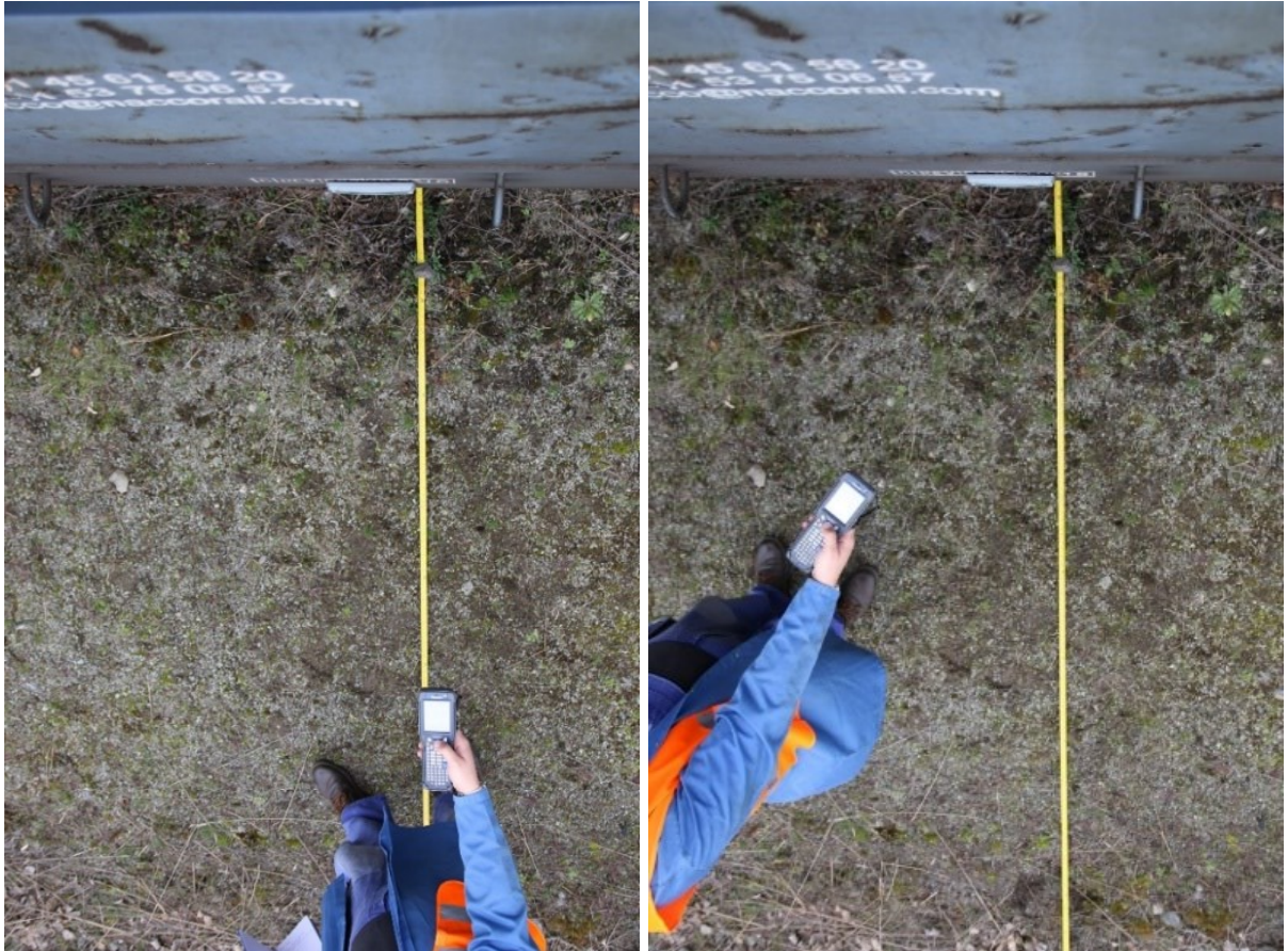
Obrázek 9 Testování tagů pod úhlem 0^\circ a 45^\circ (autor)
