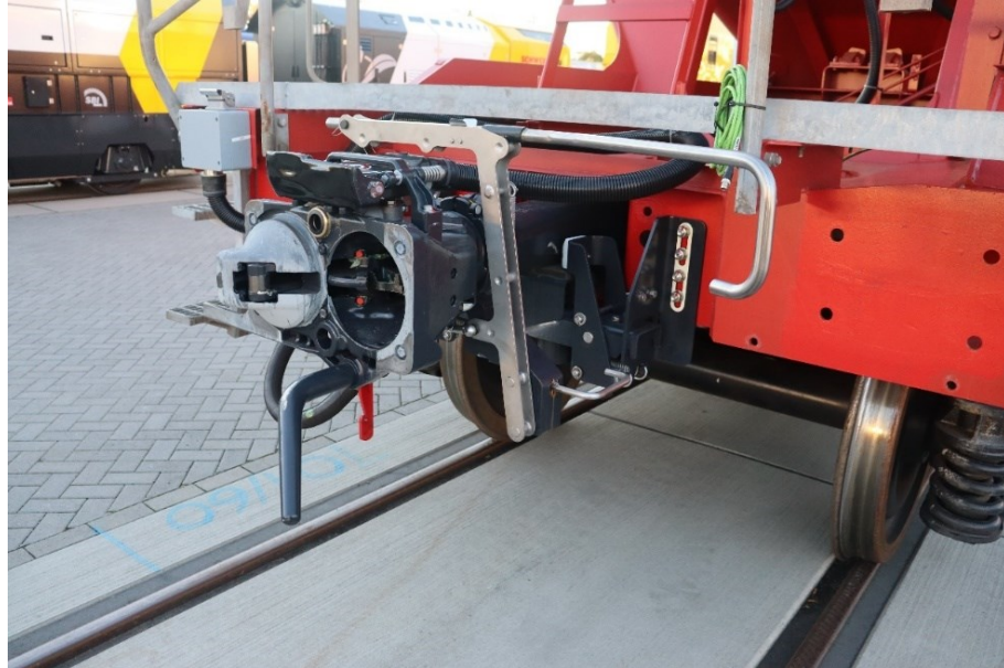
Obrázek 18 Prototyp digitálního automatického spřáhla Voith (autor)
