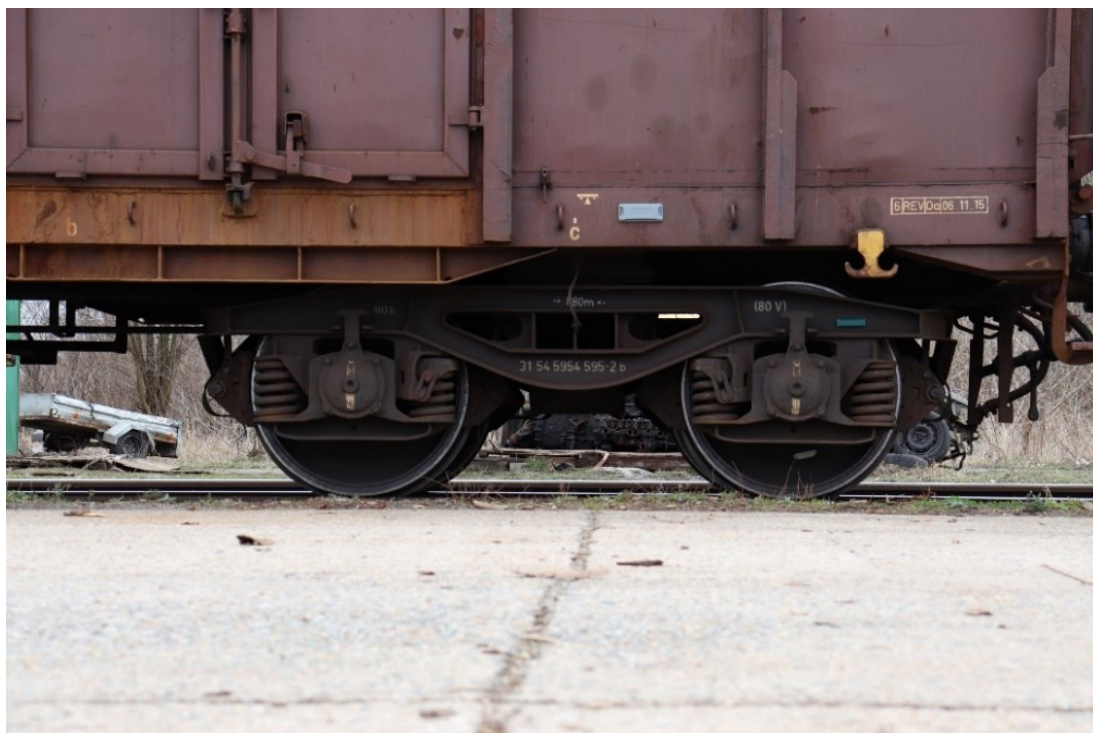
Obrázek 12 Umístění tagu na rám podvozku typu Y25 (autor)
