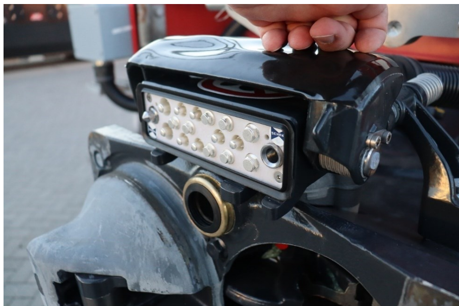
Obrázek 19 Prototyp svorkovnice digitálního automatického spřáhla Voith (autor)
