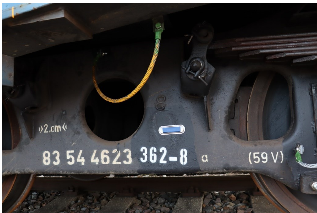
Obrázek 11 Umístění štítku na rám podvozku typu 26-2.8 (autor)
