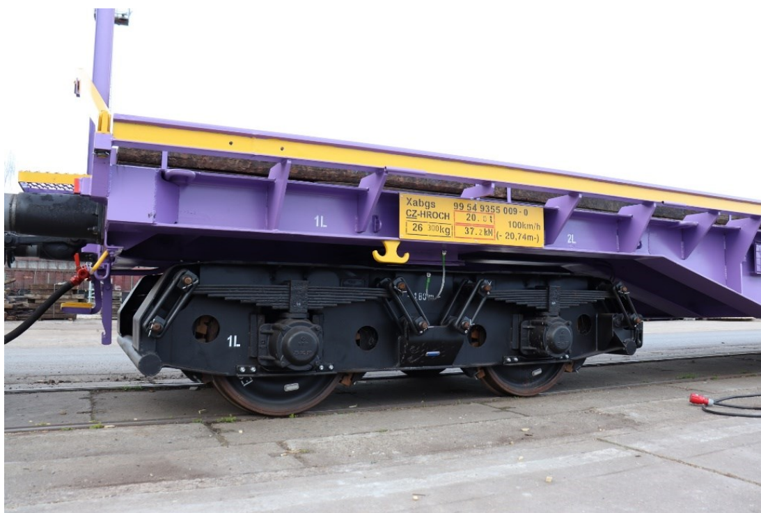
Obrázek 13 Umístění tagu na rám podvozku typu Talbot R (autor)
