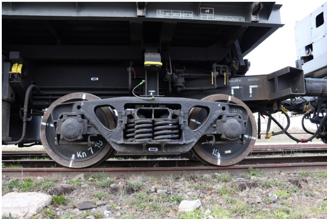
Obrázek 14 Umístění tagu na rám podvozku typu Diamond (autor)
