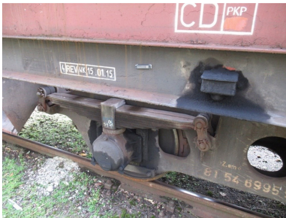
Obrázek 10 Umístění štítku na rám vozu řady Faccs (autor)
