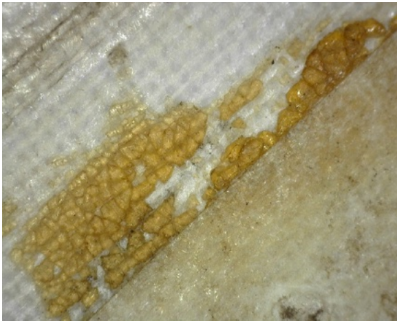
Obr. 2.17: Stav před restaurováním, detail adheziva v oblasti spoje, denní rozptýlené světlo, USB-mikroskop, rub
