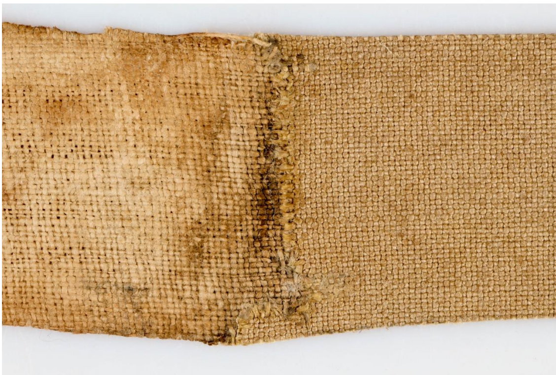
obr. 59 Detail vyspravení původního textilního horního přelepu (vlevo) novým tónovaným plátnem (vpravo)
