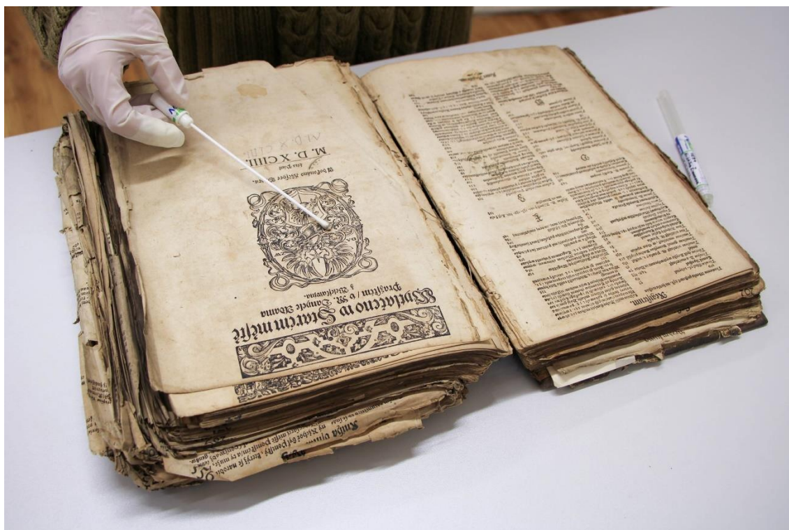
obr. 31 Odběr vzorku pro mikrobiologickou analýzu
