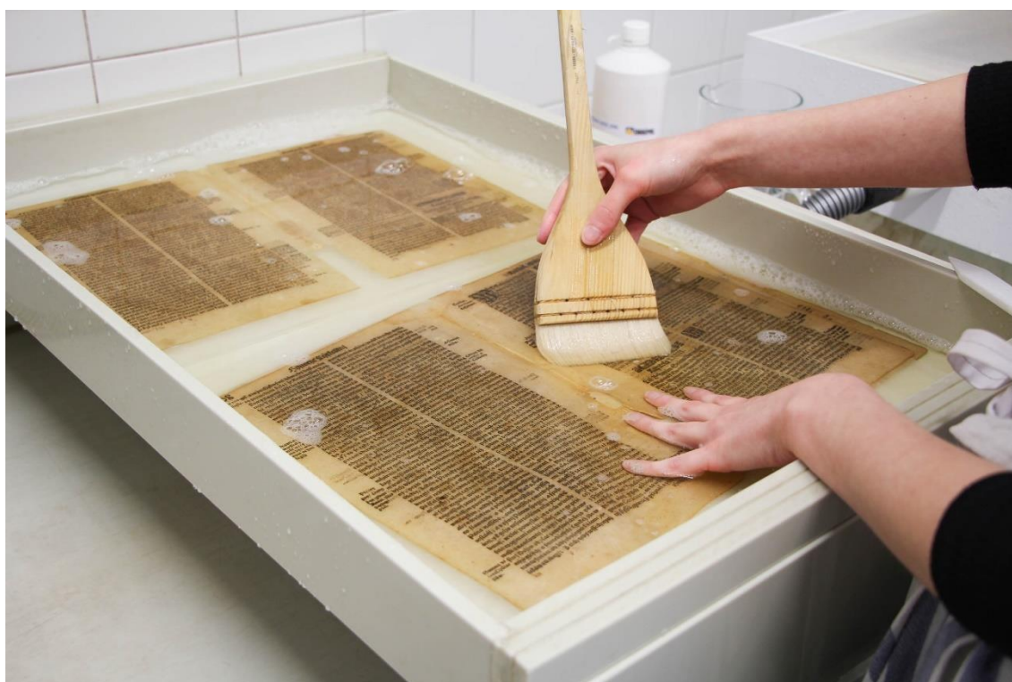
obr. 36 Čištění papírové podložky ve vodní lázni s přídavkem tenzidu Spolapon AOS 146
