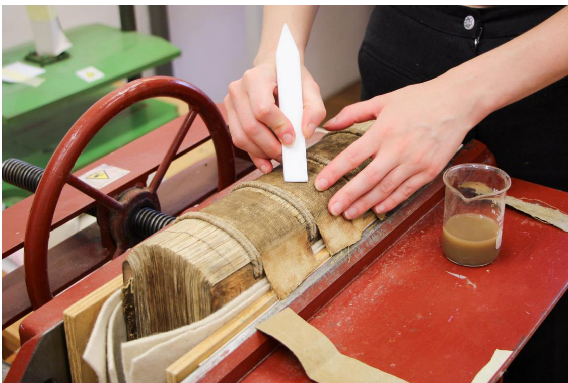
obr. 60 Lepení textilních mezivazných přelepů na hřbet knižního bloku
