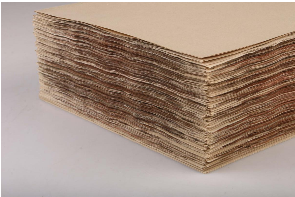
Foto. 14 Defekty listů bloku po zásahu
