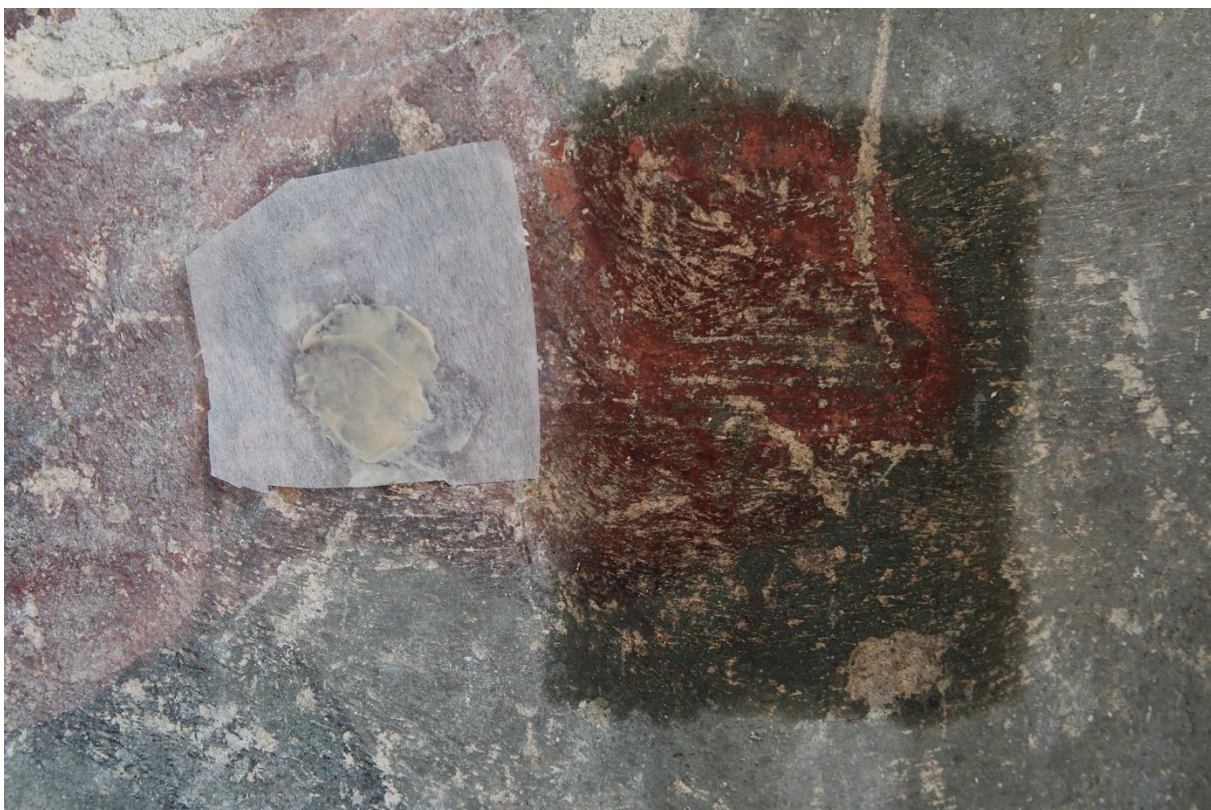
Obr. 37 Zkouška čištění iontoměníčem Ionex OH aplikovaného přes japonský papír Kashmir.
