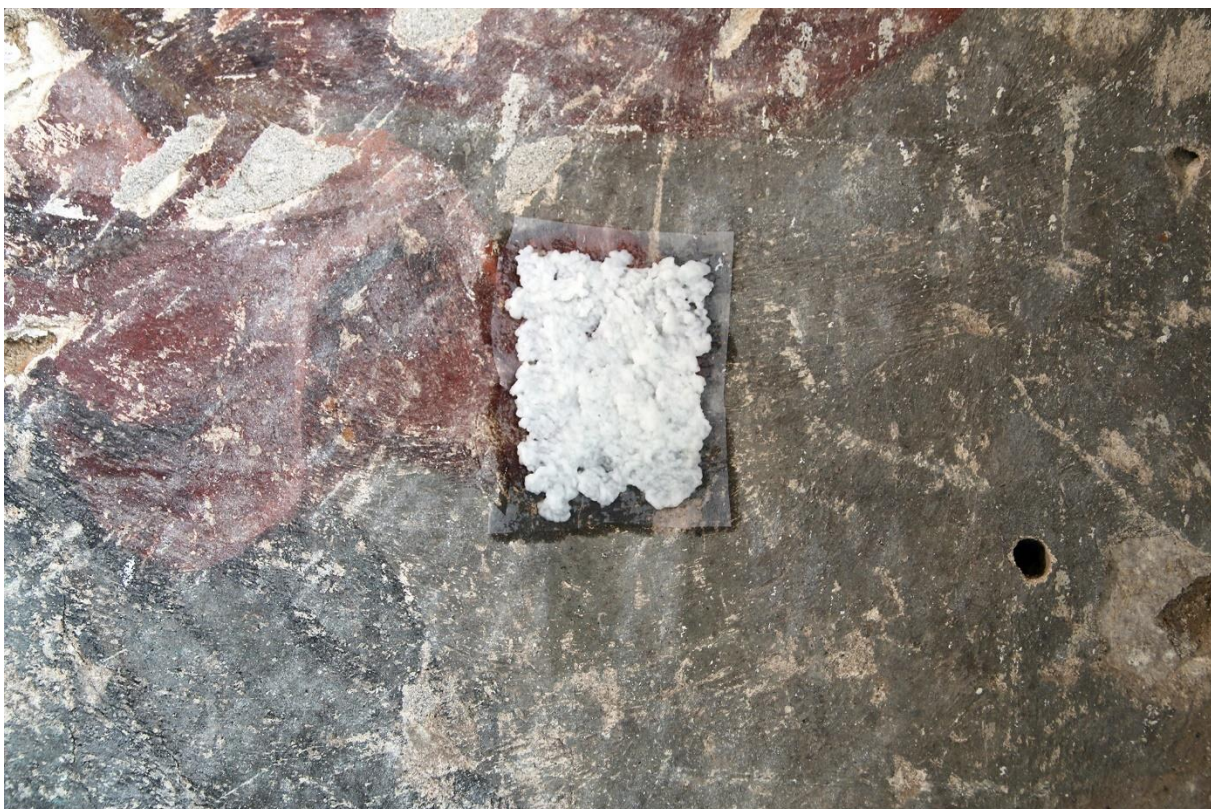
Obr. 36 Zkouška čištění 5% hm. uhličitánem amonným formou zábalu s buničinou Arbocel BC 200 přes japonský papír Kashmir 11g.
