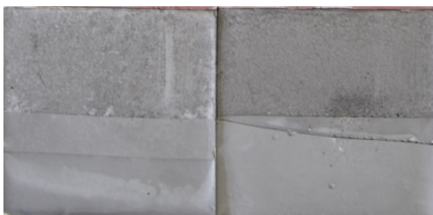
Obr. 149 Horní polovina sádrových vzorků s umělou krustou (sádra + železitá čern) očištěna pomocí: filtrovaných bakterií (nalevo) a nefiltrovaných bakterií (uprostřed)
