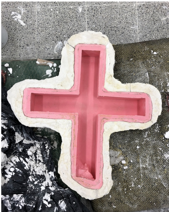
Obr. 89 Proces výroby doplňku z umělého kamene – zaformování sádrového kříže do silikonu
