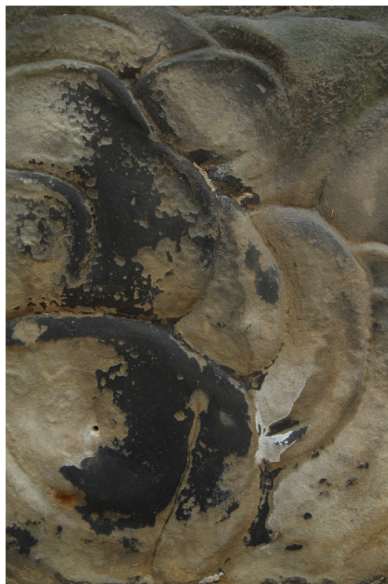
Obr. 49 Stav před restaurováním – zadní strana sousoší, detail praskliny a vykrystalizovaných solí na povrchu
