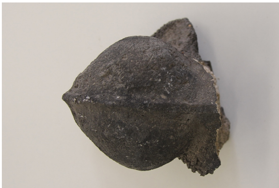
Obr. 111 Vápencový prvek s reálnou krustou A, v Materiálovém průřezu vzorek č. 3
