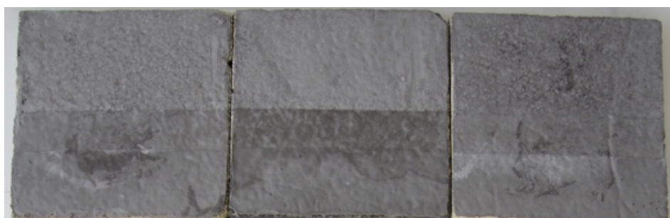
Obr. 147 Horní polovina vápencových vzorků s umělou krustou (sádra + sazová čern) očištěna pomocí: filtrovaných bakterií (nalevo), nefiltrovaných bakterií (uprostřed) a samotného fosfátového pufru (vpravo)
