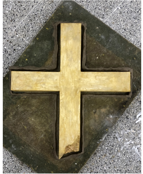
Obr. 88 Proces výroby doplňku z umělého kamene – odlití kříže do sádry pomocí silikonové formy
