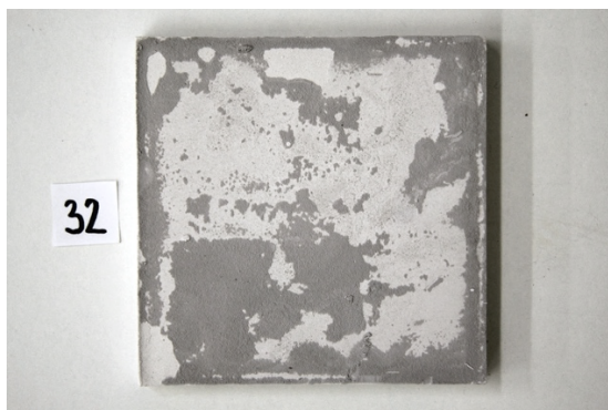
Obr. 132 Předběžné zkoušky přípravy umělých sádrovcových krust – poškození tenčí krusty vlivem přichycení k formě při obráceném postupu aplikace
