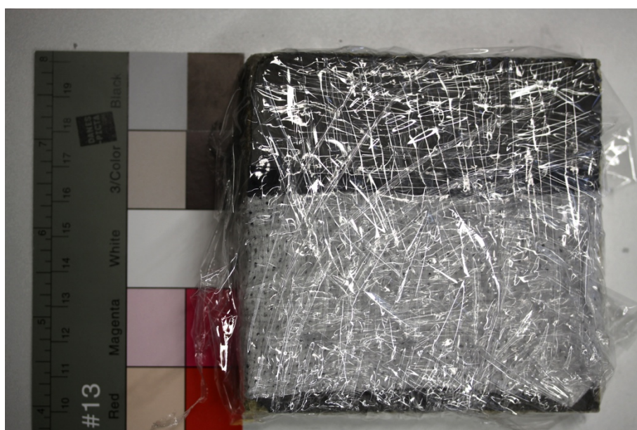
Obr. 128 Bakteriální suspenze v Carbogelu překrytá netkanou textilií s fosfátovým pufrem a polyuretanovou fólií
