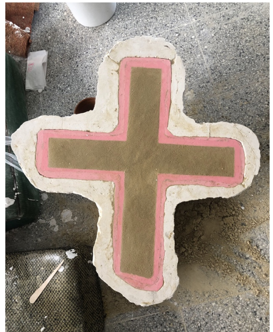
Obr. 90 Proces výroby doplňku z umělého kamene – vydusána forma kříže
