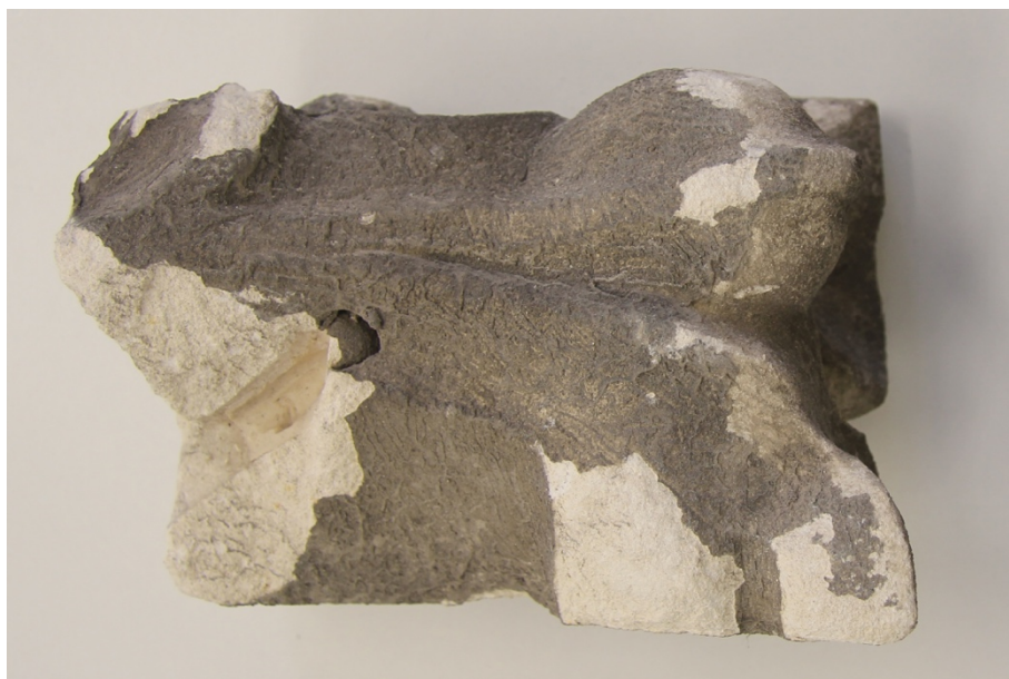
Obr. 113 Vápencový prvek s reálnou krustou B, v Materiálovém průřezu vzorek č. 4
