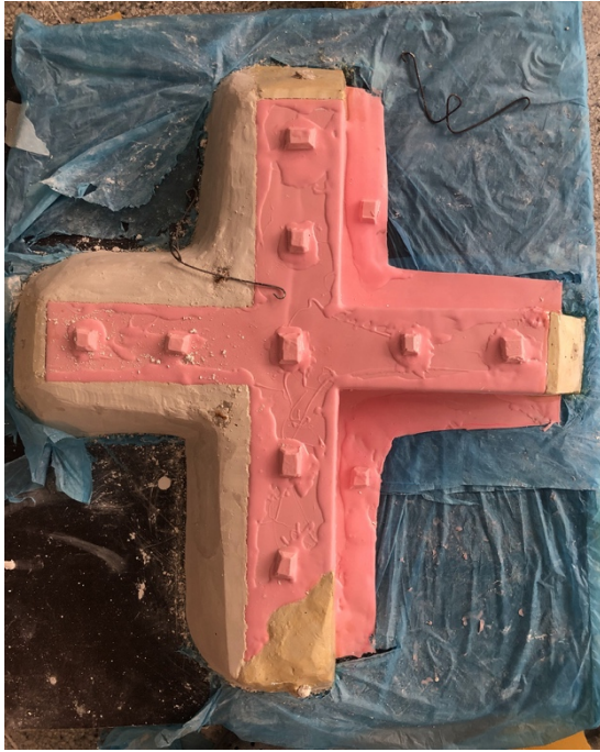
Obr. 87 Proces výroby doplňku z umělého kamene – zaformování kříže z hlíny pomocí silikonu a sádrových kadlubů
