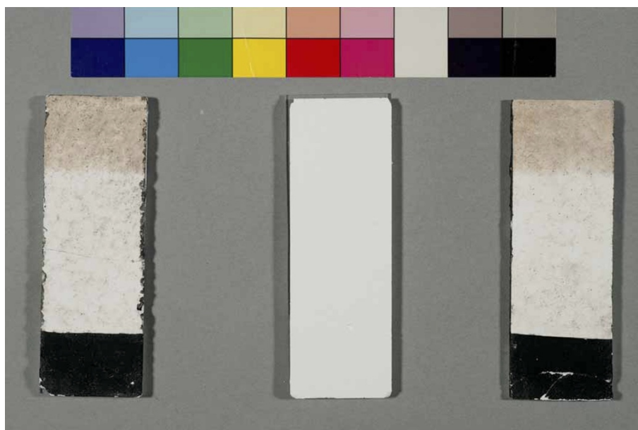
Obr. 106 Celkový pohled na dvě experimentální sádrové desky s lampovou černí aplikované za sucha (vpravo a vlevo) a na referenční desku bez znečištění (uprostřed). U experimentálních desek ve spodní části znečištěný povrch, který nebyl čištěn a byl vystaven UV-B záření, uprostřed povrch vyčištěný Nd:YAG laserem a vystavený UV-B záření a ve vrchní části desek plochy čištěné Nd:YAG laserem, avšak nevystavené UV-B záření 118
