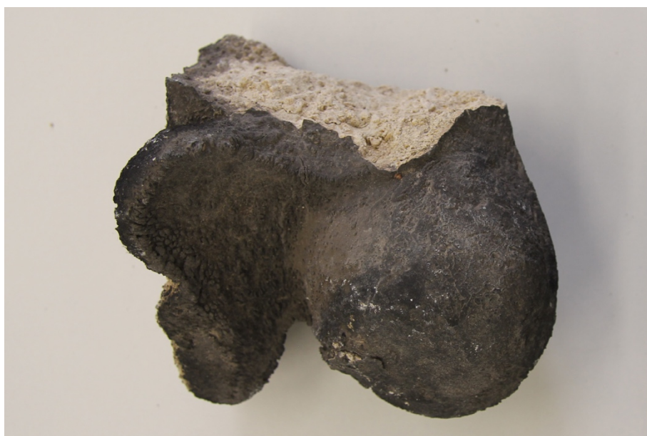
Obr. 112 Vápencový prvek s reálnou krustou A z jiného pohledu, v Materiálovém průřezu vzorek č. 3
