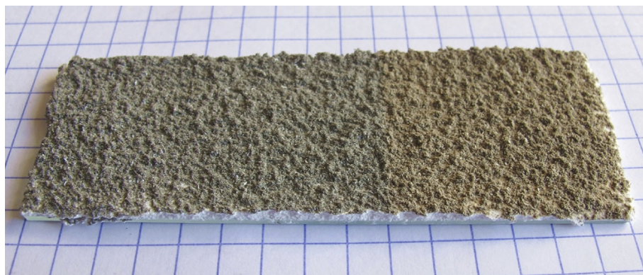
Obr. 110 Vzorek s umělou krustou připravenou z drcené přírodní krusty a sádry –stav před (vlevo) a po (vpravo) laserovém ozáření. Velikost mřížky 5 × 5 mm 2131
