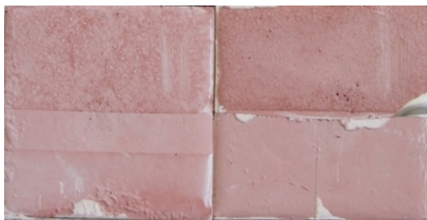
Obr. 150 Horní polovina sádrových vzorků s umělou krustou (sádra + železitá červeň) očištěna pomocí: filtrovaných bakterií (nalevo) a nefiltrovaných bakterií (uprostřed)
