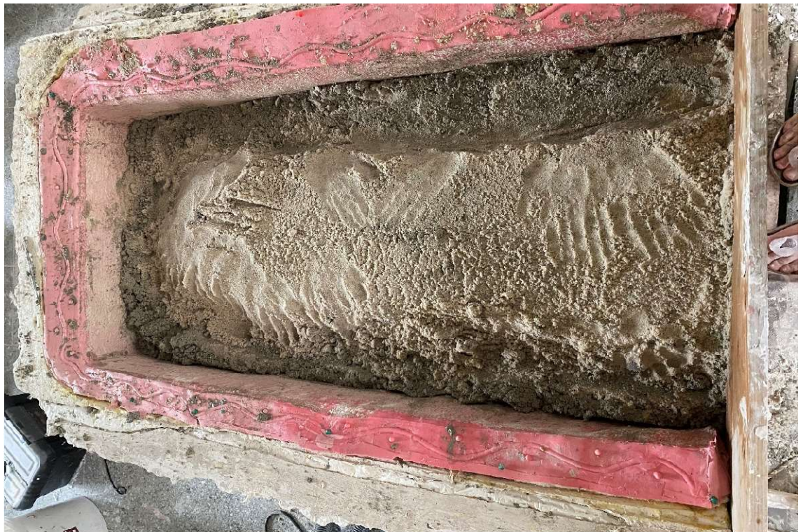
Obr. 4 Průběh dusání kopie, jádro z mokrého písku
