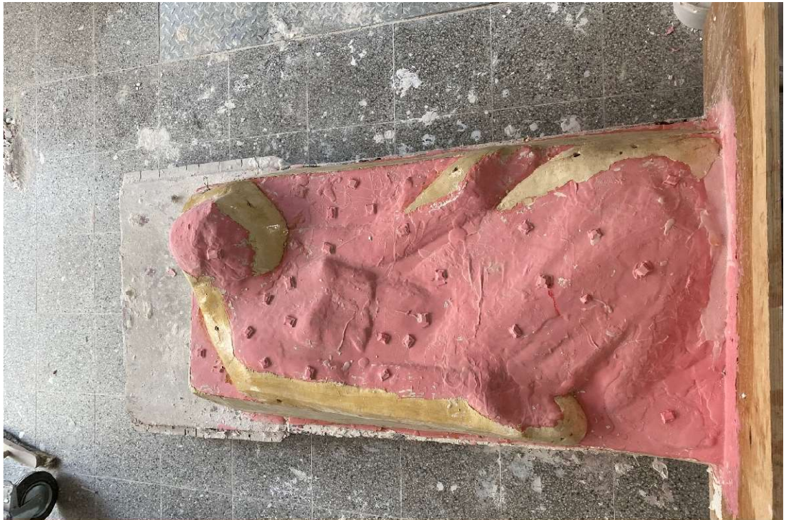
Obr. 3 Průběh formování originálu, silikonová forma společně se sádrovými klíny
