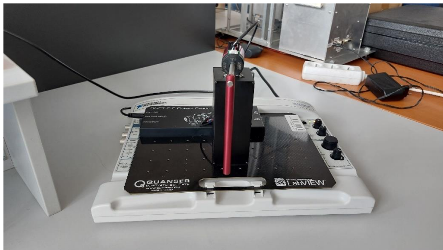
Obrázek 2.5 - Rotační inverzní kyvadlo
