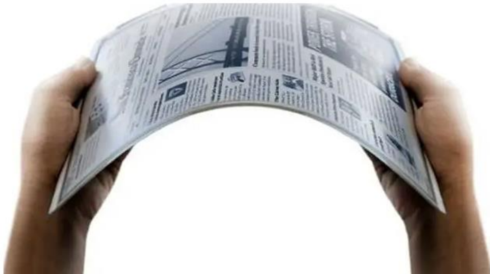
Obrázek 31 - Flexibilní elektronický papír [38]
