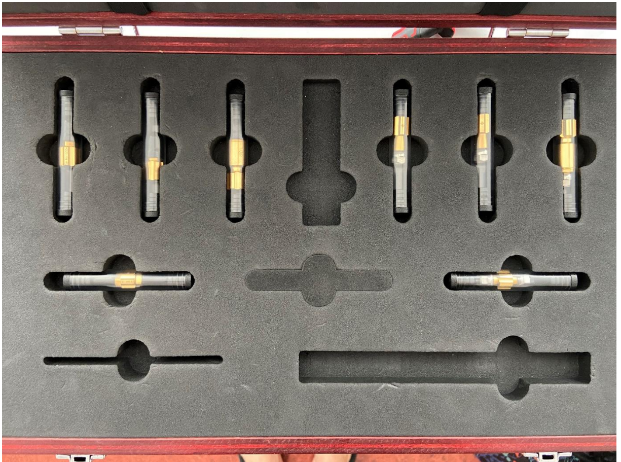
Obrázek 41 - Kalibrační sada R&S
