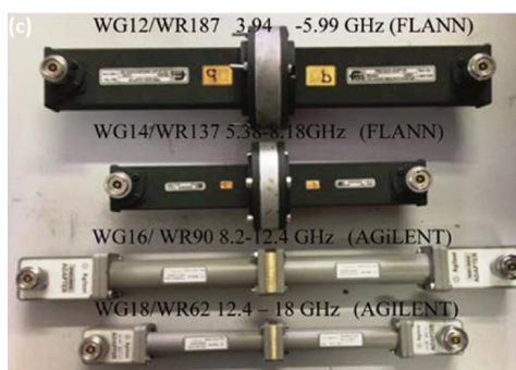
Obrázek 22 - Různé druhy vlnovodů [7]
