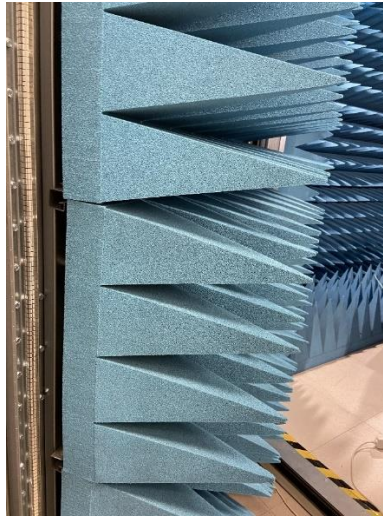
Obrázek 4 - Polyuretanový absorpční materiál
