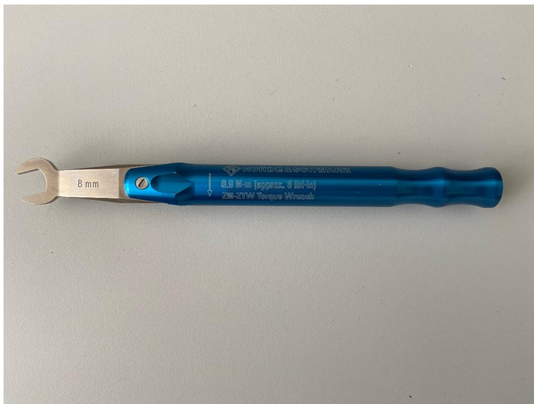
Obrázek 40 - Momentový klíč pro správné dotažení
