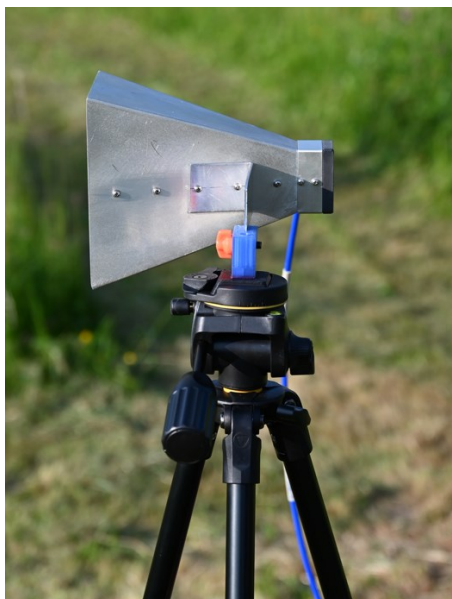
Obrázek 29 - Upevnění použité antény ke stativu (Ridge horn)
