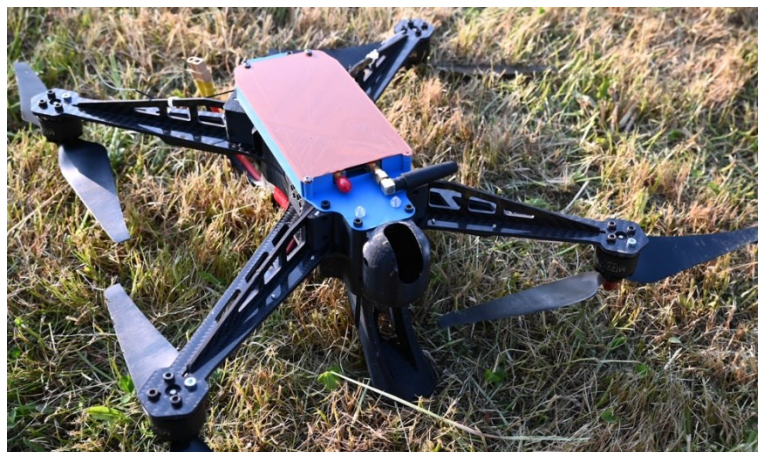
Obrázek 25 - Připevnění měřicí aparatury ke kvadrokoptěře
