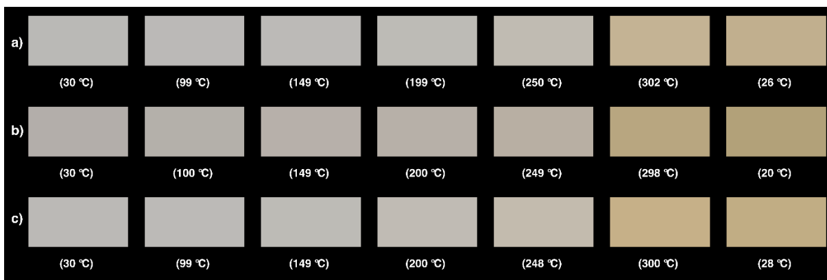
Obr. 38 – Změna barvy při lineárním termálním namáhání, vzorky TMPEO(3)TA : NPGPDA v poměru a) 1 : 3; b) 1 : 1; c) 3 : 1
