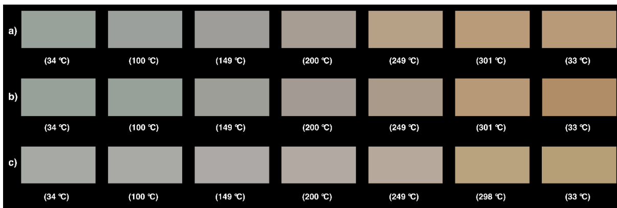
Obr. 40 – Změna barvy při lineárním termálním namáhání, vzorek PBk31 v TMPEO(3)TA : POEA v poměru a) 1 : 3; b) 1 : 1; c) 3 : 1
