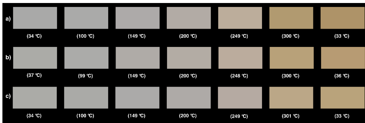
Obr. 41 – Změna barvy při lineárním termálním namáhání, vzorek PBk31 v TMPEO(3)TA : NPGPDA v poměru a) 1 : 3; b) 1 : 1; c) 3 : 1
