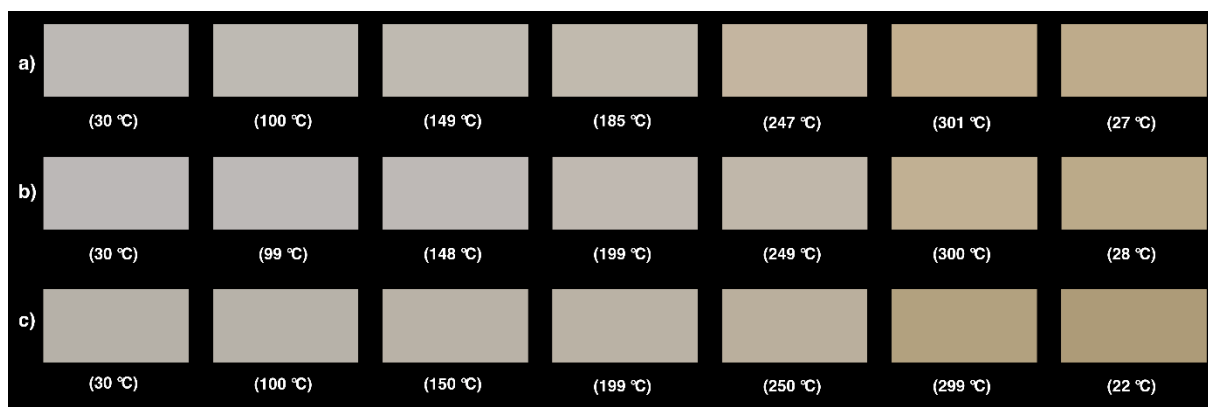
Obr. 37 – Změna barvy při lineárním termálním namáhání, vzorky TMPEO(3)TA : POEA v poměru a) 1 : 3; b) 1 : 1; c) 3 : 1
