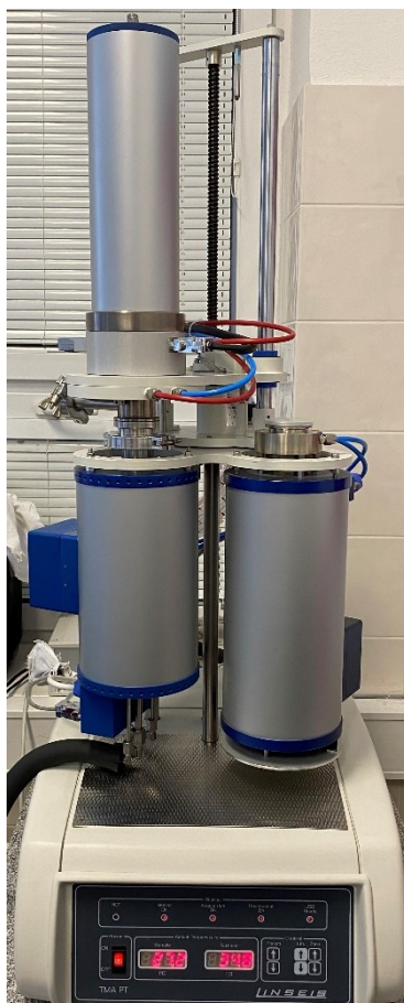
Obrázek 5: Termomechanický analyzátor TMA PT 1600
