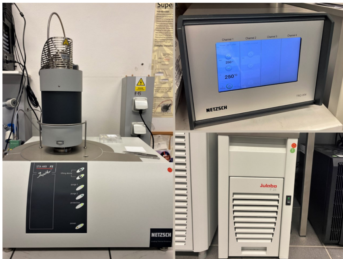
Obrázek 14: Vlevo – termogravimetrický analyzátor; vpravo nahoře – termostat vah; vpravo dole – vyhřívací zařízení bránící kondenzaci odváděných plynů.
