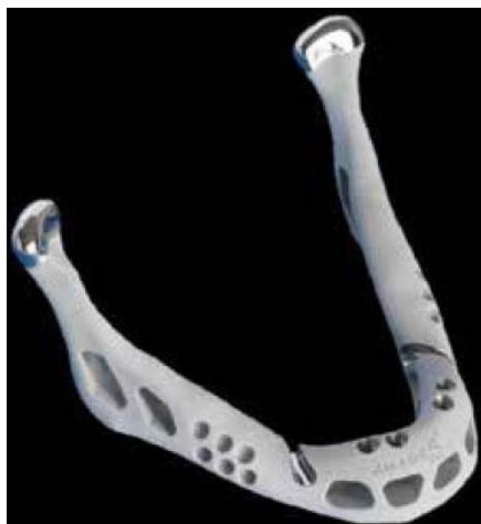
Obrázek 3: Titanová náhrada čelisti vytvořená 3D tiskem. [19]
