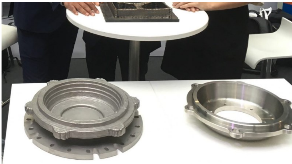
Obrázek 2 – Náhradní díl pro lokomotivu zhotovený aditivní technologií [5]
