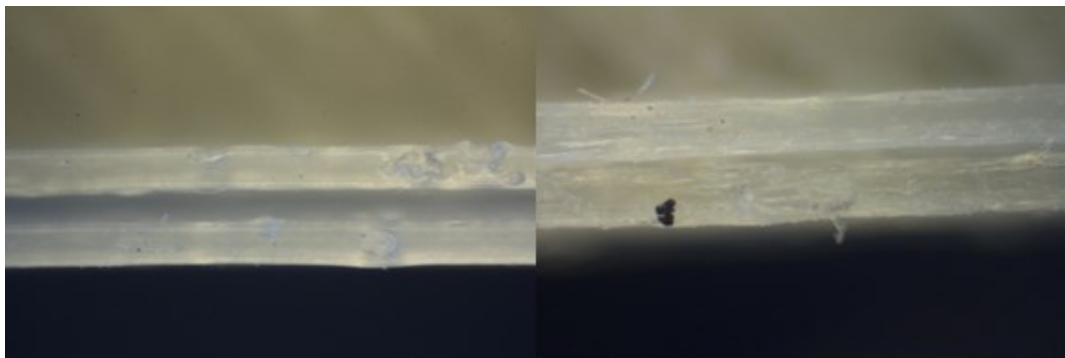
Obrázek 87 – Stěna tělíška před a po optimalizaci, 120 mm/s (PVA)
