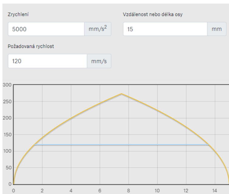
Obrázek 45 – Profil rychlosti pohybu tiskové hlavy [58]
