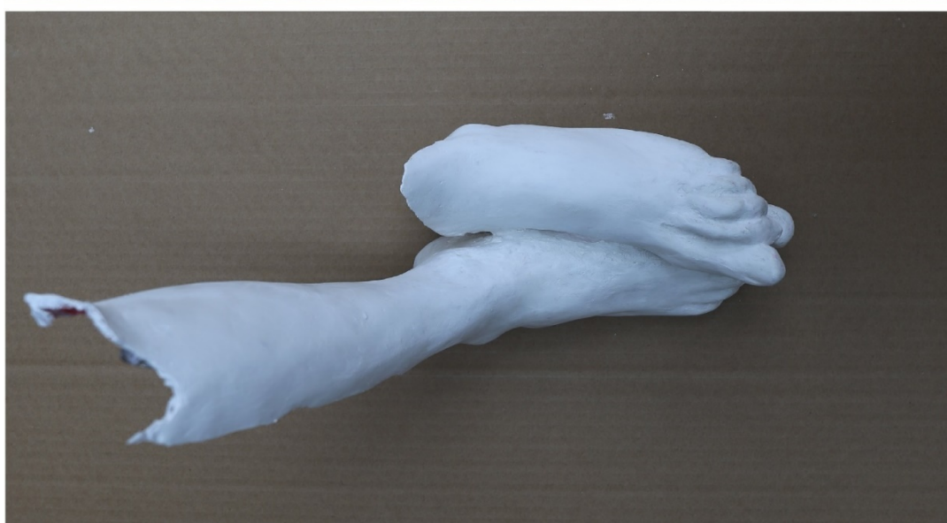
Obr. č. 85 První 3D doplněk (materiál PLA) s podkladovou barvou a finální povrchovou úpravu. Uvnitř jsou osazeny magnety na epoxidové lepidlo Akepox Akemi 5010. Fotografie pořízeny 3.3.2023
