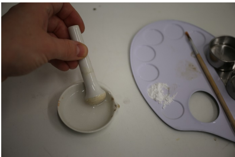
Obr. č. 69 Příprava podkladové barvy z práškového pigmentu zinkové běloby a 3% roztoku Klucelu G ve vodě ve třecí misce proti zabránění vzniku hrudek pigmentu a jeho rovnoměrné disperzi v pojivu. Fotografie pořízena 1.2.2023
