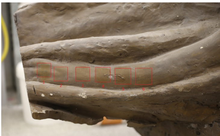
Obr. č. 19 Zkoušky suchého čištění, provedené na přední části levé ruky díla.
