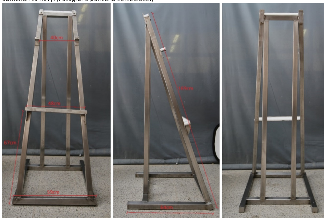
Obr. č. 52 Nerezová konstrukce pro objekt sochy Touhy s rozměry. Fotografie pořízeny 14.12.2022
