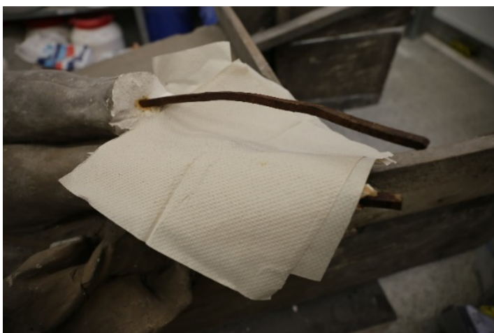
Obr. č. 44 Stabilizace nátěrem 10% roztoku šelaku v 97% ethanolu. (Fotografie pořízena 10.11.2022.)
