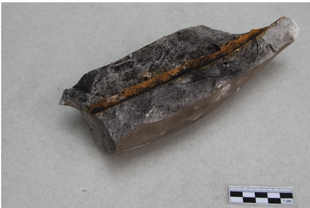
Obr. č. 38 Odlomená část levé nohy, ostatní fragmenty chybí. Na povrchu rez od armatury. Stav před restaurováním. Fotografie pořízeny 27.5.2022
