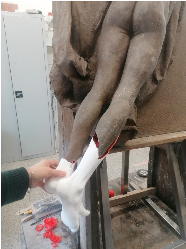
Obr. č. 66 Povrchová úprava doplňku č.1 z PLA pomocí akrylátového tmelu PG 6020 (firma Pro Gold) a akrylátové barvy pro důsledné zakrytí prosvitajícího tisku. (Fotografie pořízeny 18.2.2023)
