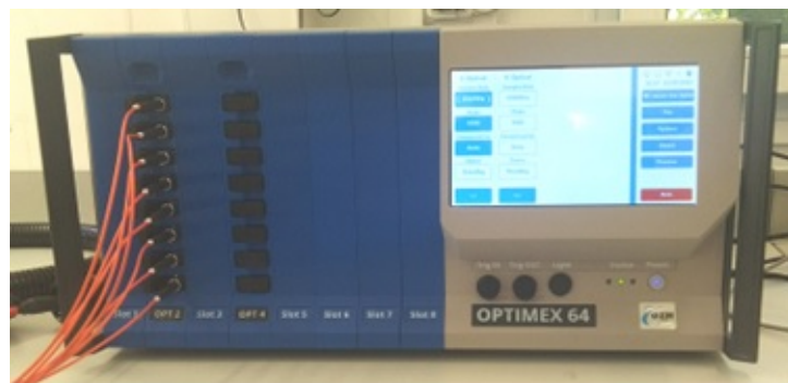
Obrázek 3.4: Fotografie přístroje OPTIMEX 16 se zapojenými osmi optickými vlákny v jedné záznamové kartě.
