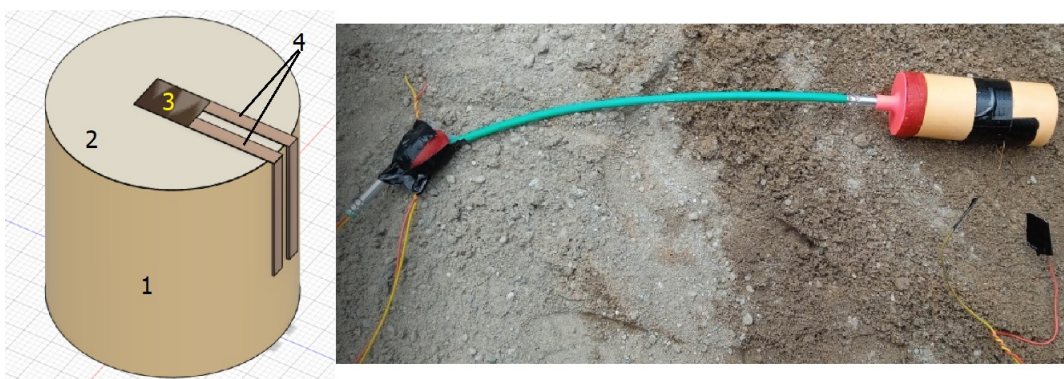
Obrázek 4.6: Model spodní náložky (1) se senzorem (3) přilepeným na teflonovou fólii (2) a vyvedenými vodiči (4) (vlevo). Fotografie experimentu s připravenou bleskovicí pro vytvoření zpoždění (vpravo).
