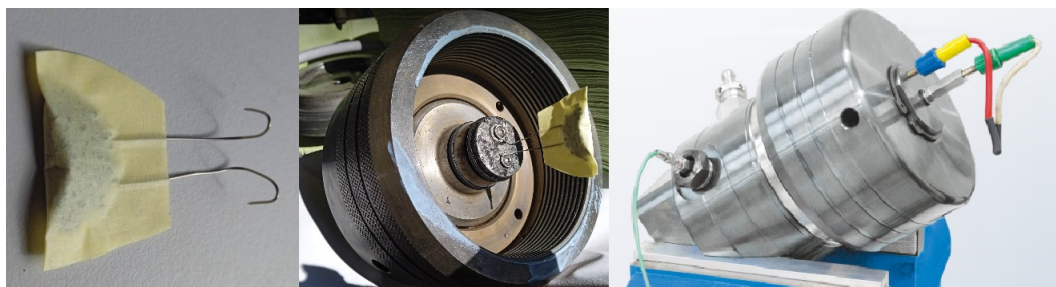
Obrázek 4.9: Foto připraveného vzorku, jeho upevnění na zážehové dráty a celé bomby TSV 40.
