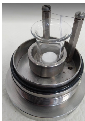
Obrázek 4.19: Foto spodní části kalorimetrické bomby s připravenou tabletou kyseliny benzoové ve skleněném kalíšku se zavedenou zážehovou bavlnkou.
