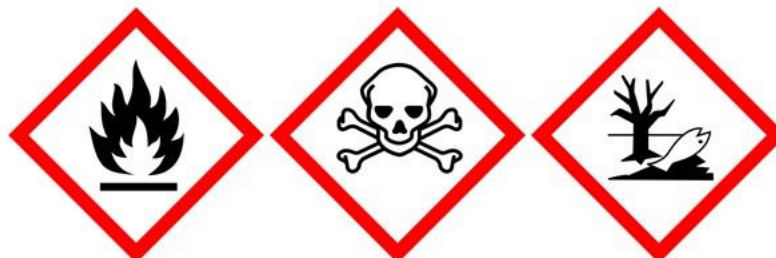
Obrázek 5 Výstražné symboly nebezpečnosti pro chemické látky podle Nařízení o klasifikaci, označování a balení (ES č. 1272/2008)
