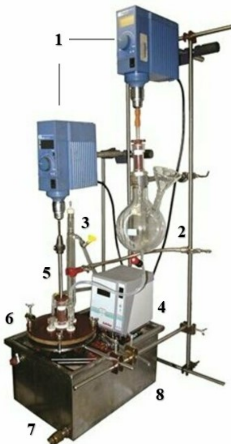
Obrázek 14: Aparatura k emulzní polymeraci, 1- míchadlo, 2- emulgační baňka, 3- zpětný chladič, 4- termostat, 5- přívod inertního plynu, 6- těsnící kryt na polymerační reaktor, 7- polymerační reaktor, 8- vodní lázeň s ohřevacím tělesem; převzato a upraveno z:(Machotová, 2016)
