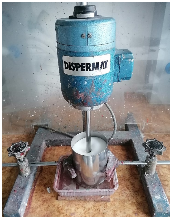
Obrázek 25: Dispergace v predispergátoru DISPERMAT
