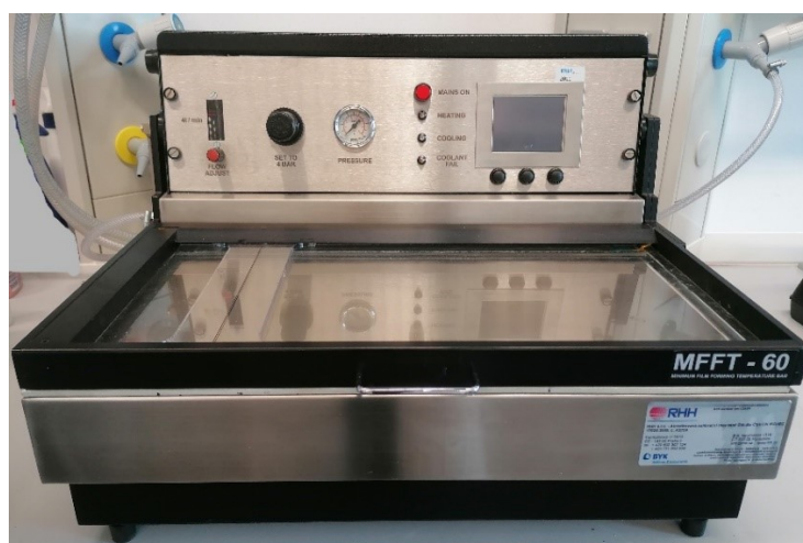
Obrázek 28: Přístroj MFFT-60 ke stanovení minimální filmotvorné teploty
