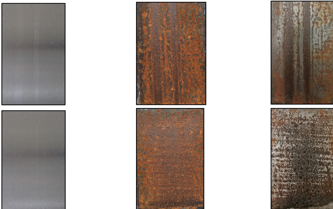
Nátěrové filmy s obsahem nanočástic \text{La}_2\text{O}_3 při OKP= 0,5 – 1 – 1,5 – 2 %
