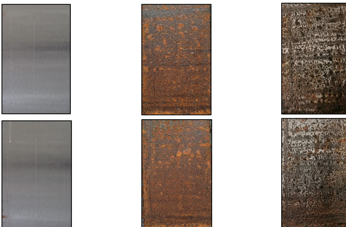
Nátěrové filmy s obsahem nanočástic \text{La}_2\text{O}_3 při OKP= 0,5 – 1 – 1,5 – 2 %
