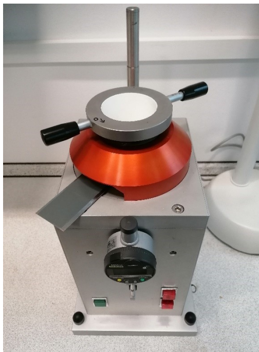
Obrázek 32: Erichsenův přístroj k měření odolnosti nátěru vůči hloubení
