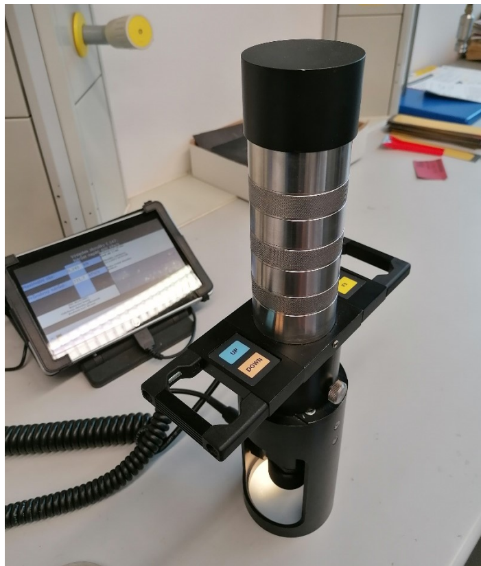
Obrázek 34: přístroj CONTEST®OP3 pro stanovení přilnavosti nátěrů odtrhovou zkouškou
