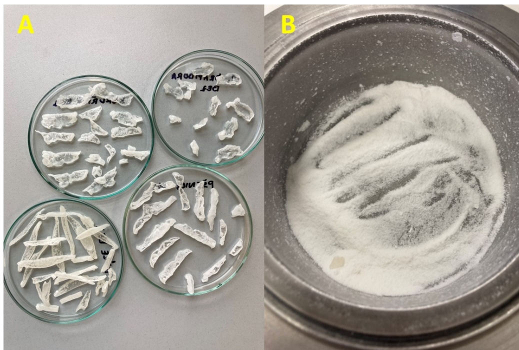
Obrázek 20: A) Hydrogely nastříhané na zhruba 2mm plátky před sušením. B) Namletý hydrogel na jemný prášek
