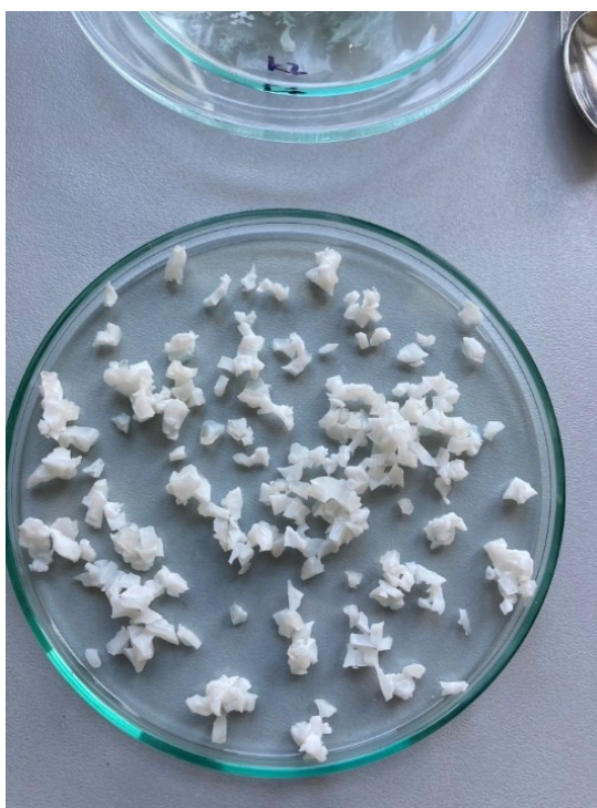
Obrázek 19: Hydrogel nastříháný na kousky o přibližné velikosti 1×1 mm
