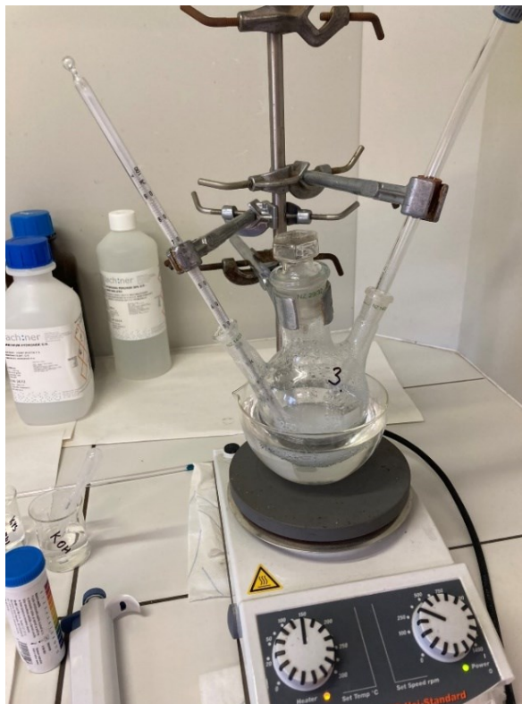
Obrázek 17: Aparatura použitá pro syntézy hydrogelů
