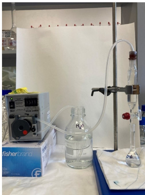
Obrázek 22: Aparatura pro dynamické testování hydrogelu
