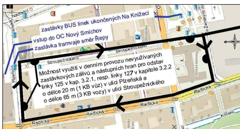
Obrázek 23 Schéma návrhu ukončení linek 125 a 127 v zastávce Anděl
