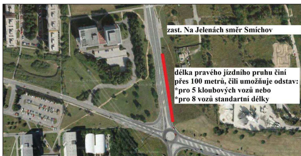
Obrázek 22 Schéma návrhu ukočení linek 115, 127 a 167 v zastávce Na Jelenách
