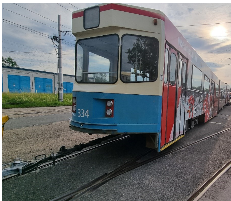
Zdroj: Universal Transport Praha s.r.o, 2022 Obrázek 17 – Sjíždění tramvaje
