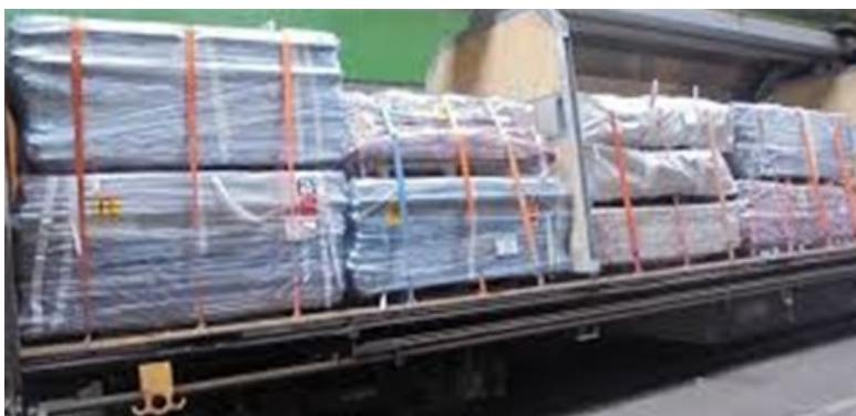
obrázek 5 Naložený železniční vůz řady Habbillins zdroj: (autor)
