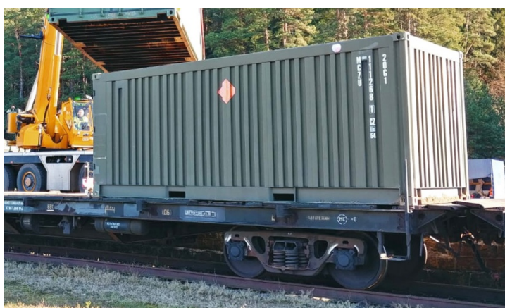
Obrázek 4 Kontejner ISO 1C
