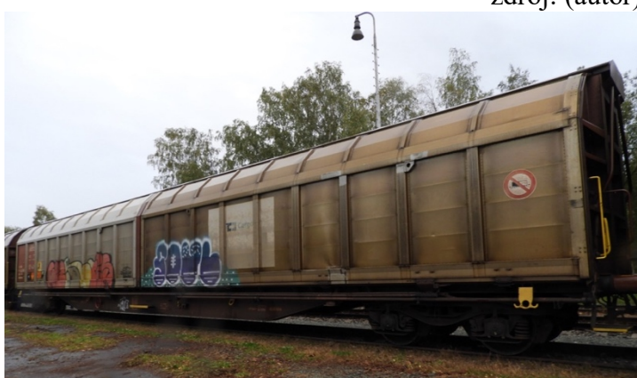
Obrázek 3 Železniční vůz řady Habbillinss
