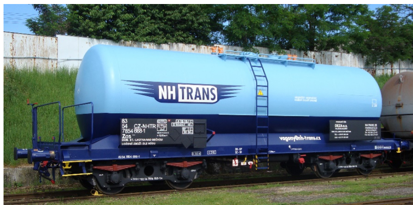
Obrázek 2 Cisternový vůz řady Zas(Ra)
