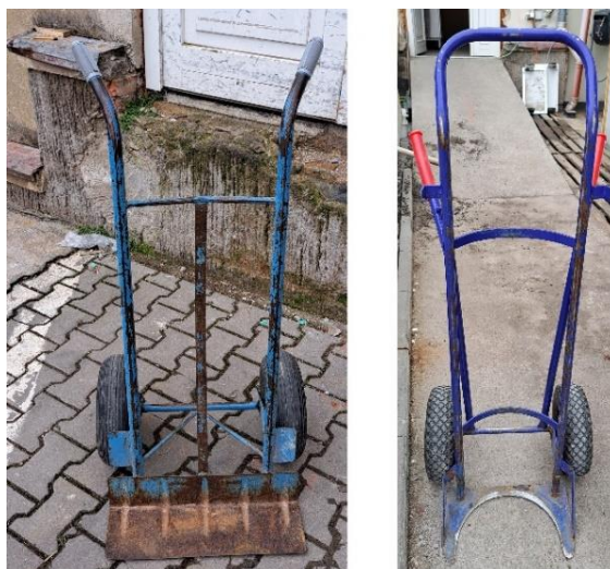
Obrázek 8 – Zleva: Rudl s plochým průřezem a rudl s půlkruhovým průřezem
