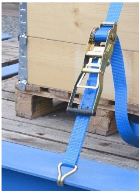
Obrázek 10 Zajištění zboží prostřednictvím textilního popruhu s ráčnou
