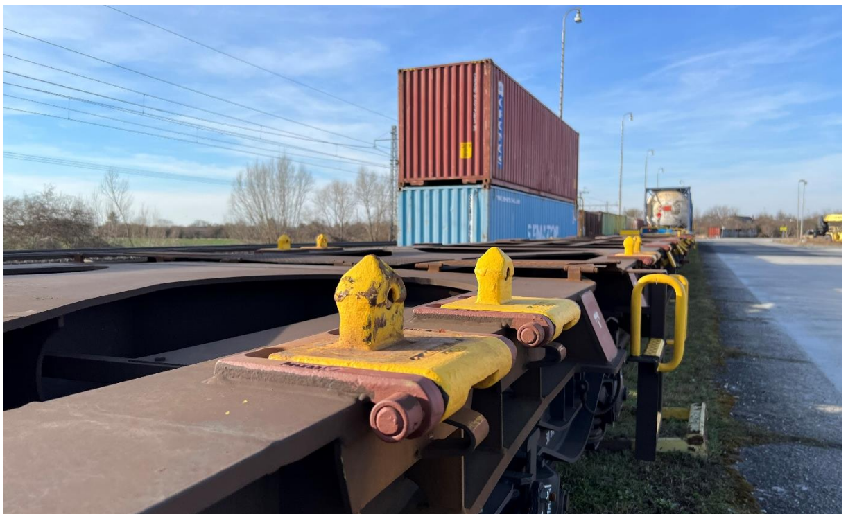
Obrázek 8 Trny pro zajištění ISO kontejnerů na železničním voze
