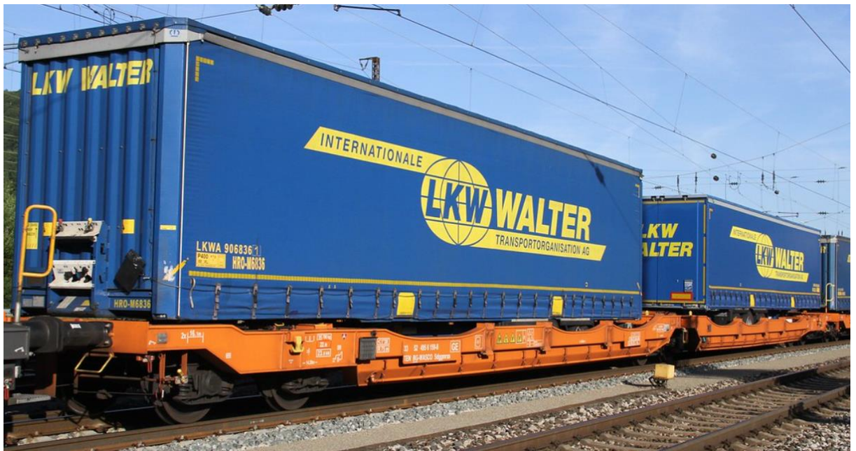
Obrázek 23 Intermodální vůz řady Sdggmrss – přeprava intermodálních návěsů
