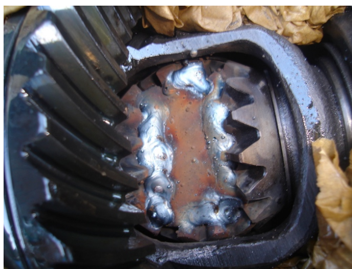
obr. 24: Zavařený diferenciál BMW E36 [25]
