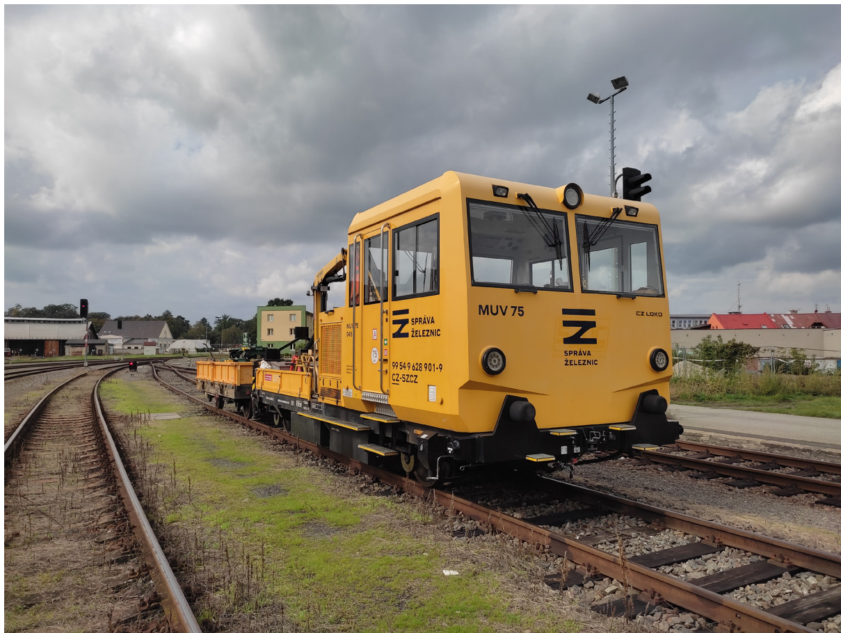
Obr. 1: Vozidlo MUV 75 společně s přívěsným vozíkem. Zde v konfiguraci s hydraulickou rukou a určením pro provoz na konvenčních drahách. Fotografie: autor práce
