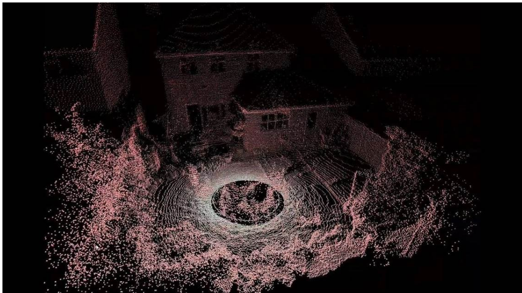
Obrázek 4: Zobrazení mračka bodů vytvořeného laserovým skenováním. Zdroj: Cambridge, 2018
