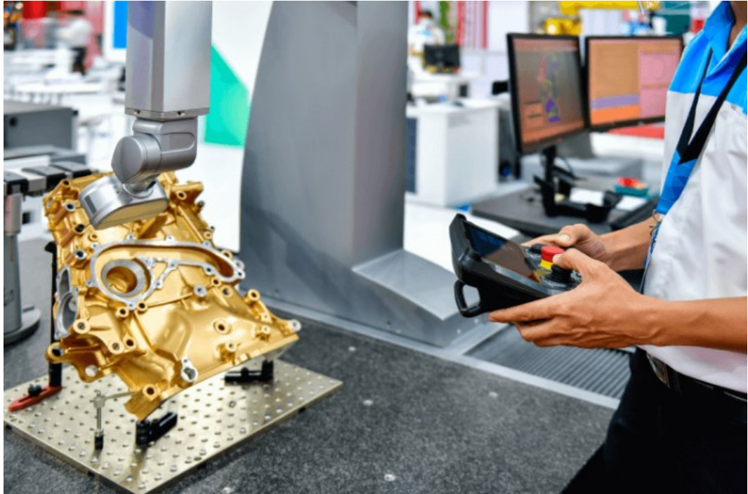
Obrázek 7: CMM při skenování automobilového dílu. Zdroj: McMillion, 2021
