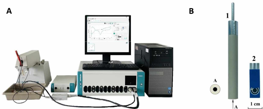
Obrázek 12 Potenciostat Autolab PGSTAT 12 (A) a použité senzory (1 – BDDE, 2- SP/BDDE)
