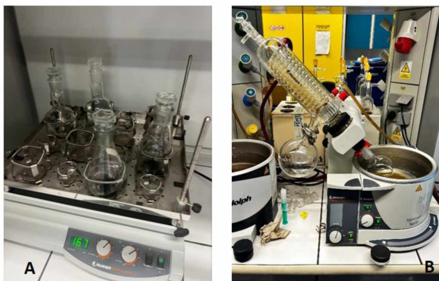
Obrázek 15 Stolní třepačka s umístěnými baňkami (A) a vakuová rotační odparka (B).
