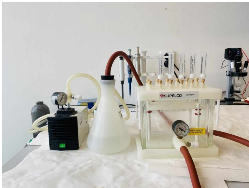
Obrázek 14 Zařízení Visiprep SPE Vakuum Manifold s kolonkami Chromabond C18ec s pojistnou nádobou a vývěvou.
